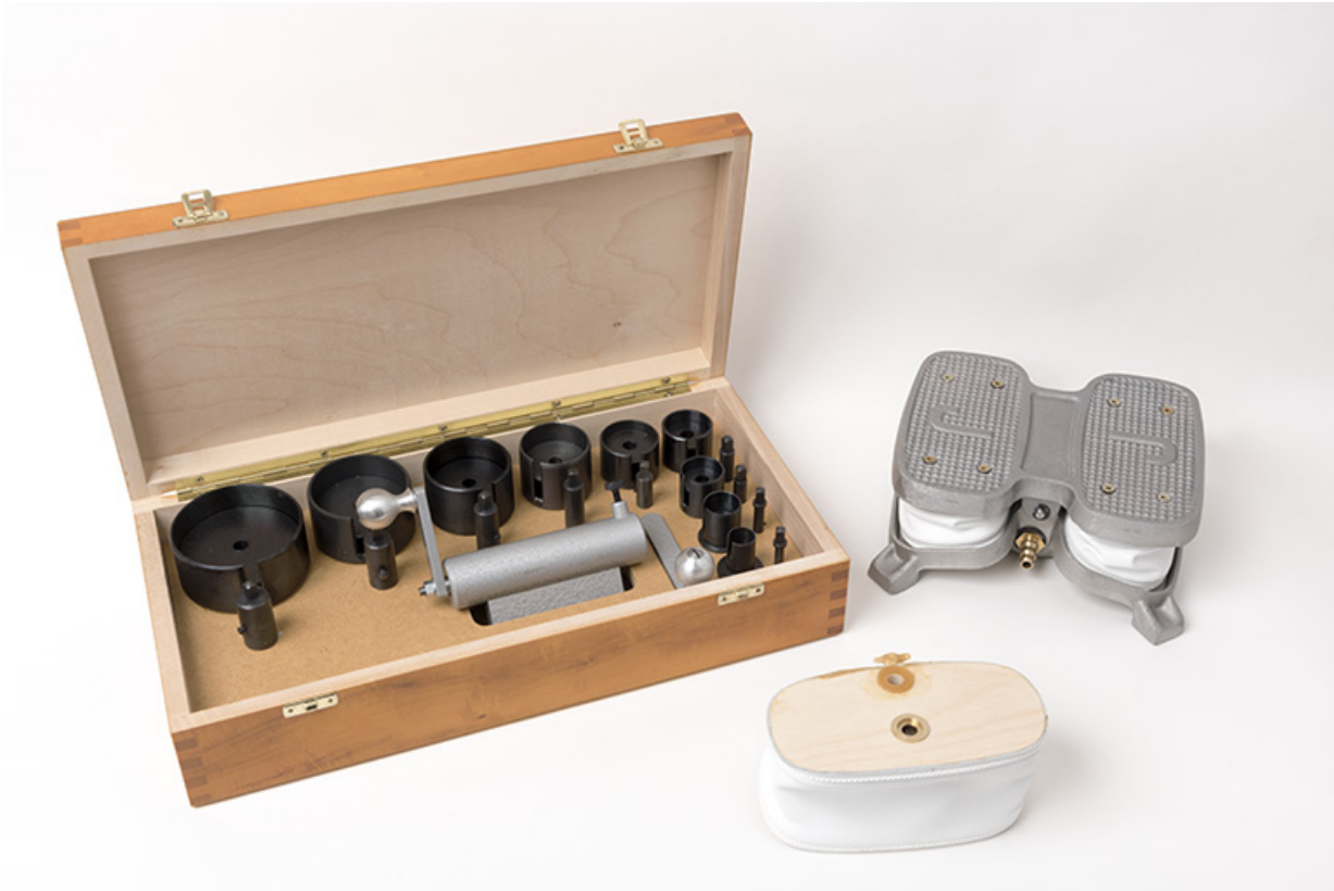
Production de la société Grandidier : estrapade pour pendule et soufflet à pied pour chalumeau de bijoutier. 25, Grand'Combe-Châteleu, 14 rue les Grands Saules, lieudit : les Forges
