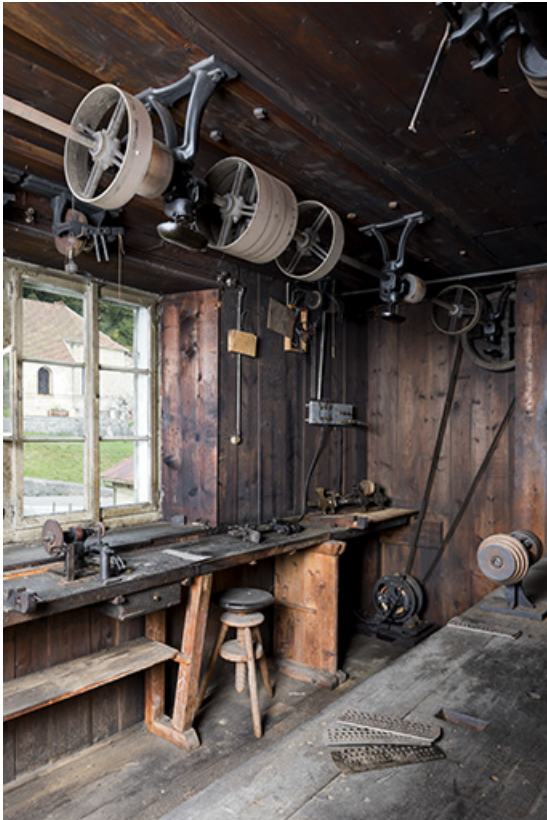
L'atelier, avec moteur électrique et transmissions.
