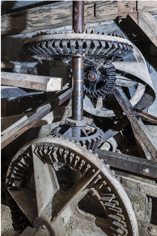
Rez-de-chaussée. Mécanisme de transmission par roues engrenées.
