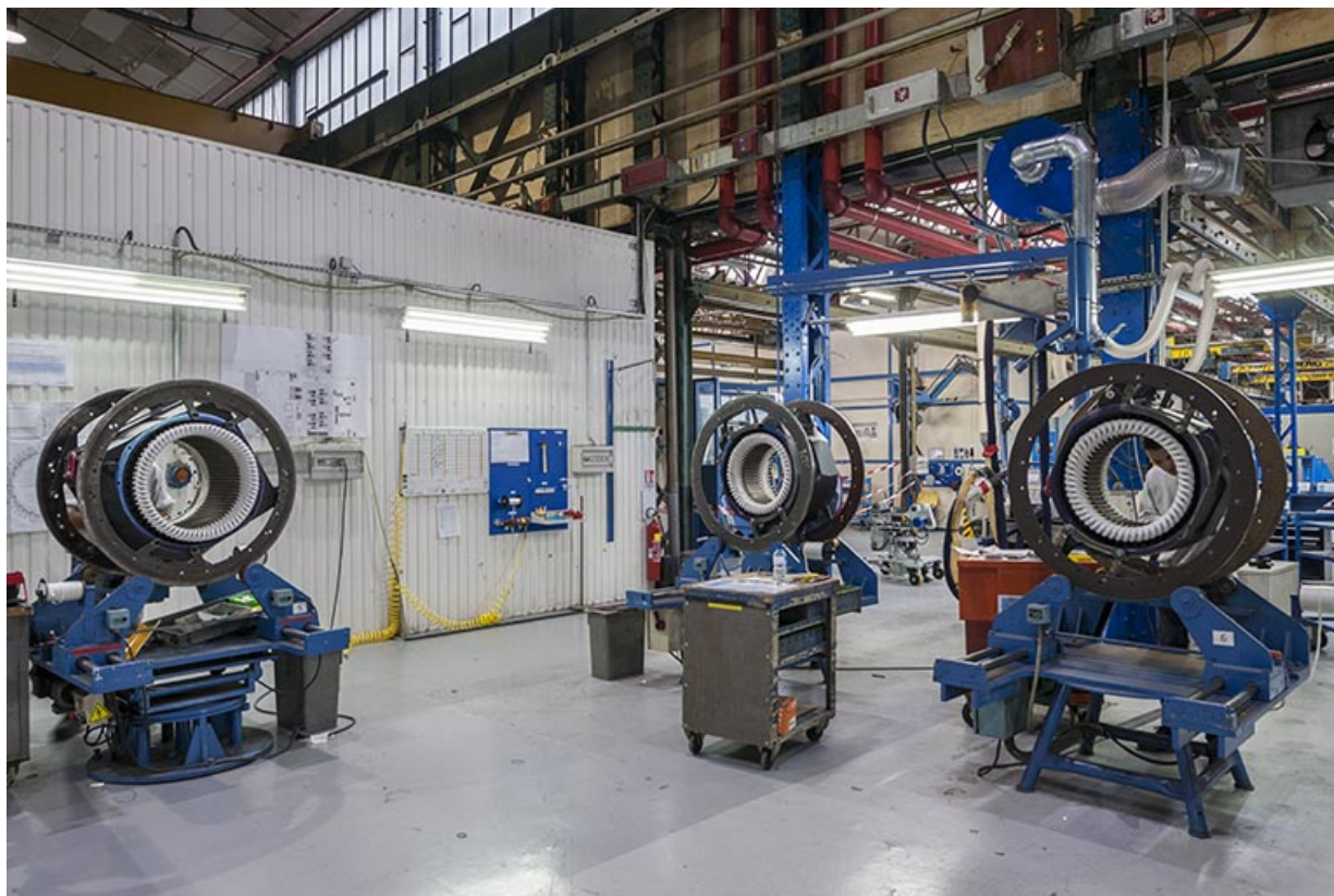
Atelier de bobinage. Equipement des stators.
