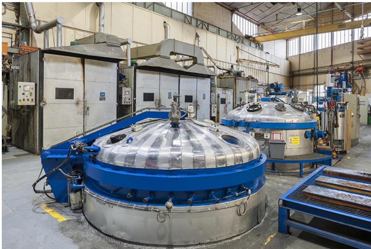
Autoclaves (imprégnation de vernis des stators).
