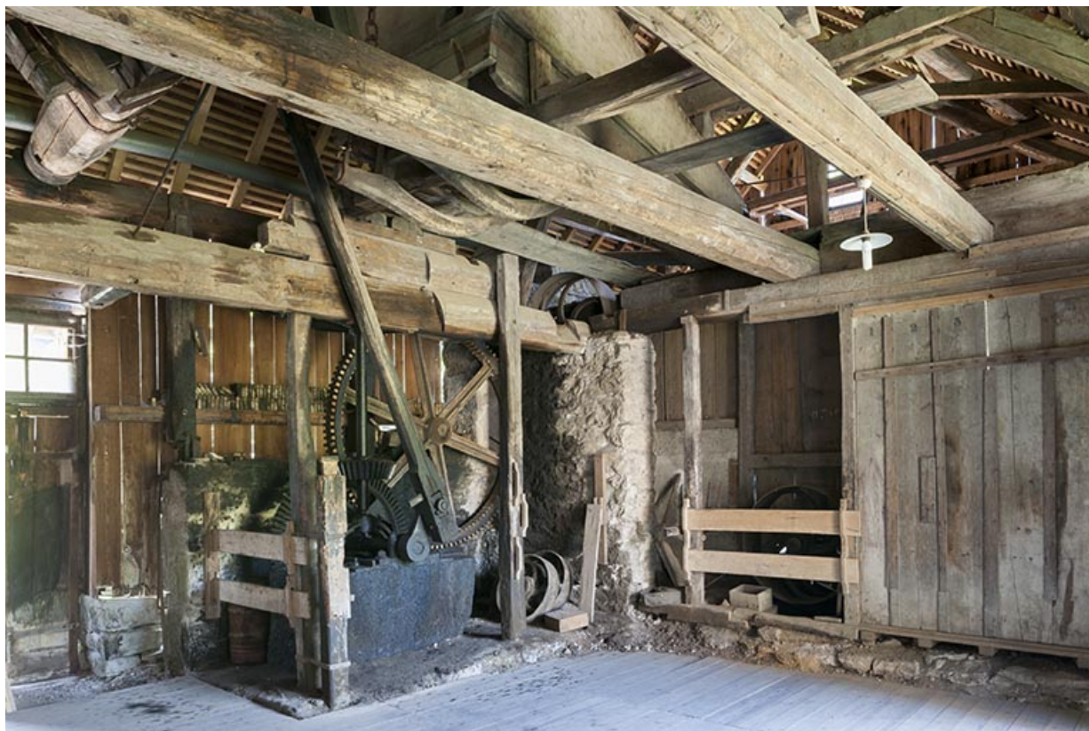
Pièce de la machine soufflante. En partie inférieure, système de transmission par bielle.
