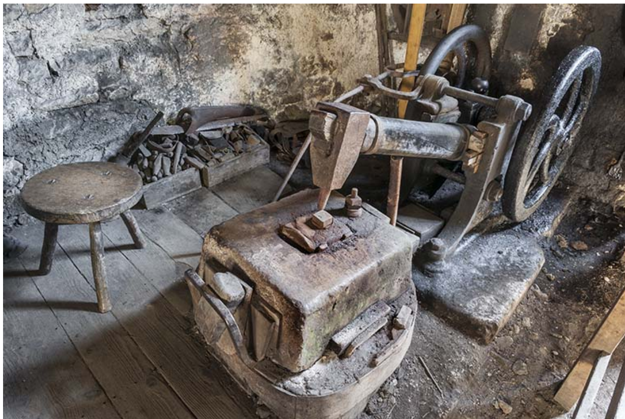
Atelier de mécanique. Martinet de finition.
