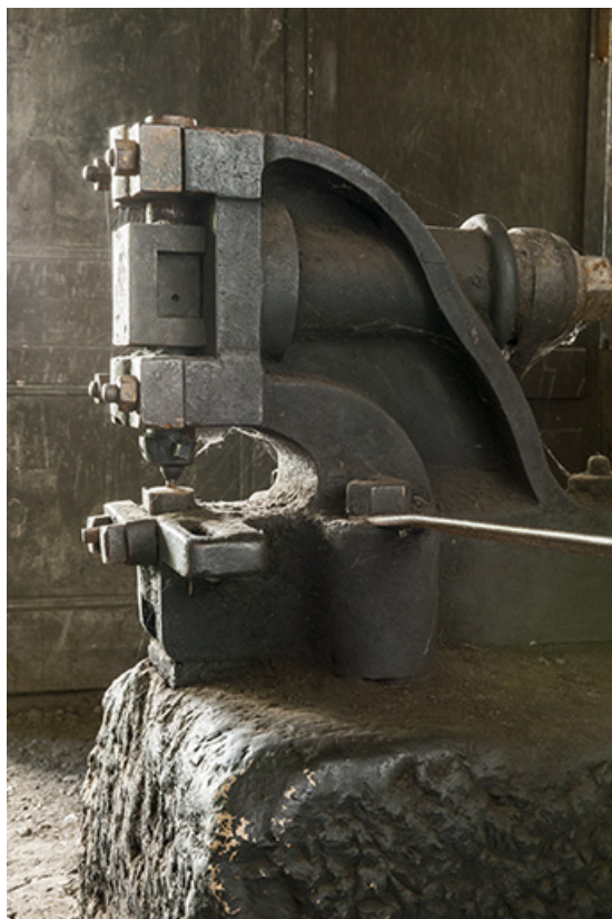
Atelier de mécanique. Poinçonneuse vue de côté.
