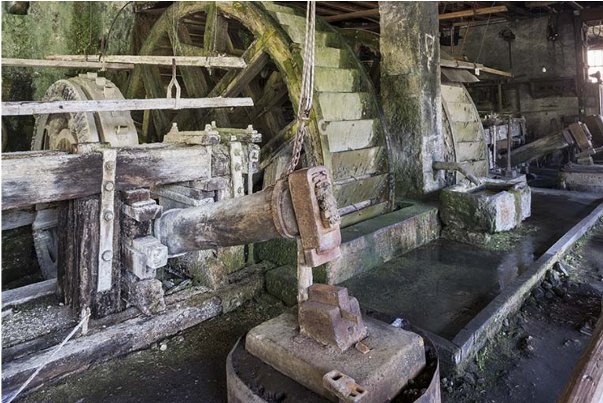
Les martinets et leurs roues motrices.
