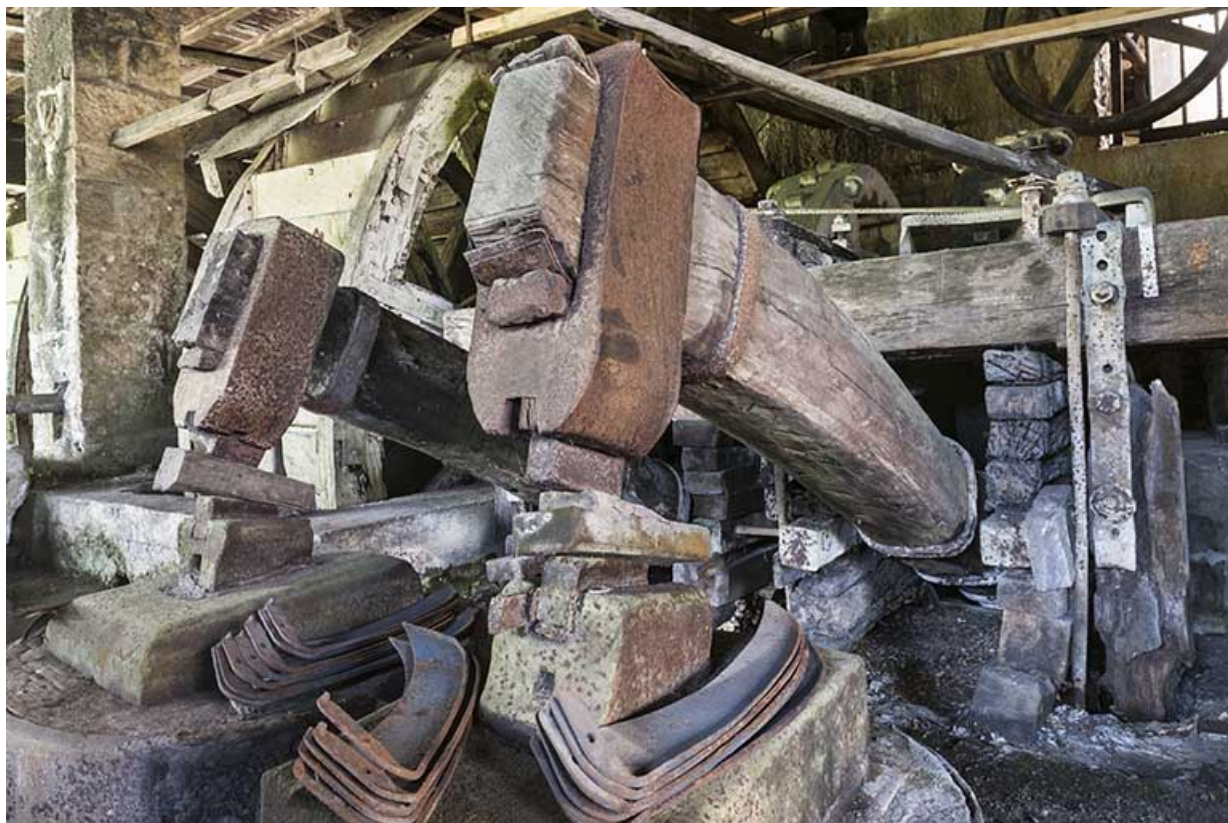
Détail des martinets ouest.
