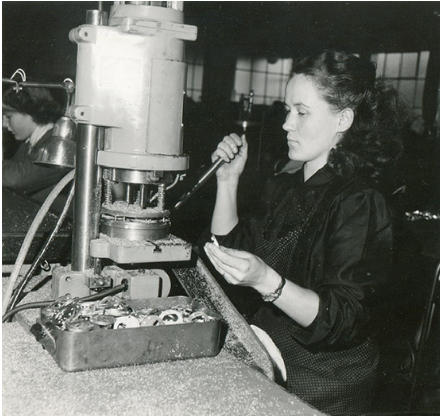
[Une ouvrière au travail : usinage de platines], vers 1950 ? 25, Villers-le-Lac, 5-9 rue Hippolyte Parrenin
