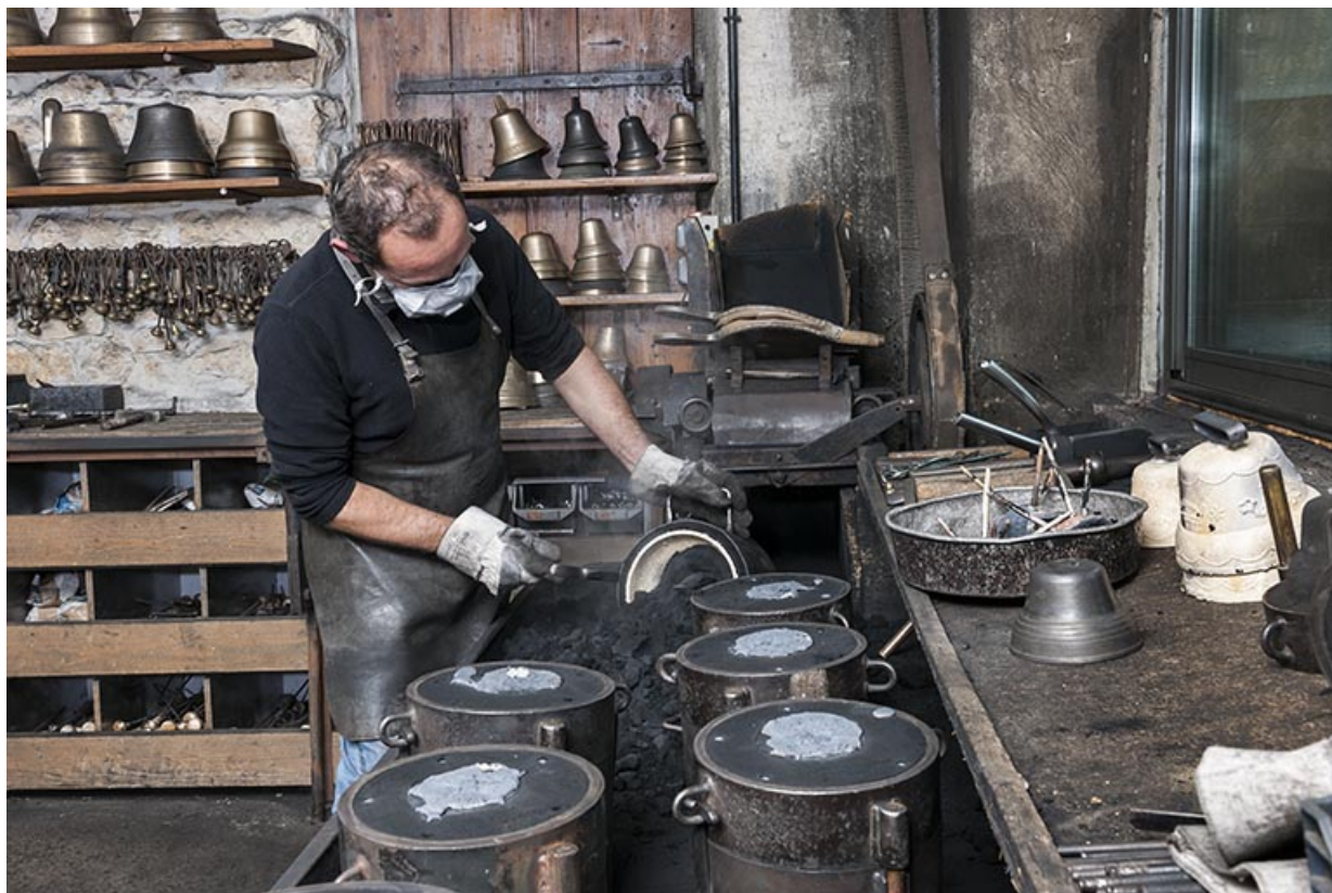
Démoulage. Extraction de la cloche (3).
