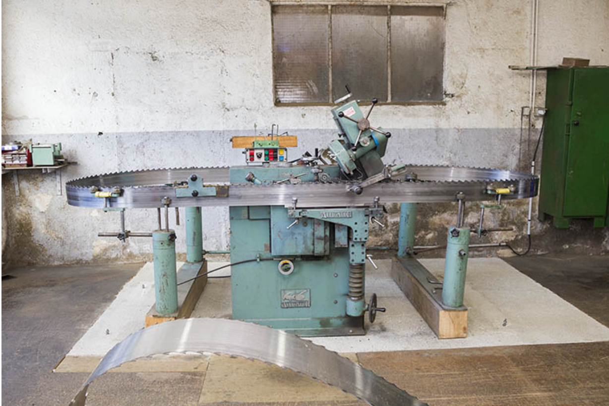
Atelier d'affûtage (K) : machine pour l'affûtage des lames de scie à ruban. 25, Maîche rue de la Scierie
