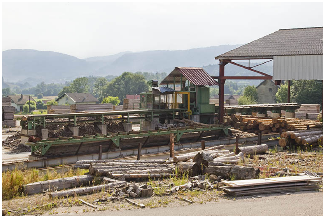
Parc aux grumes : convoyeur et écorceuse Segem.
