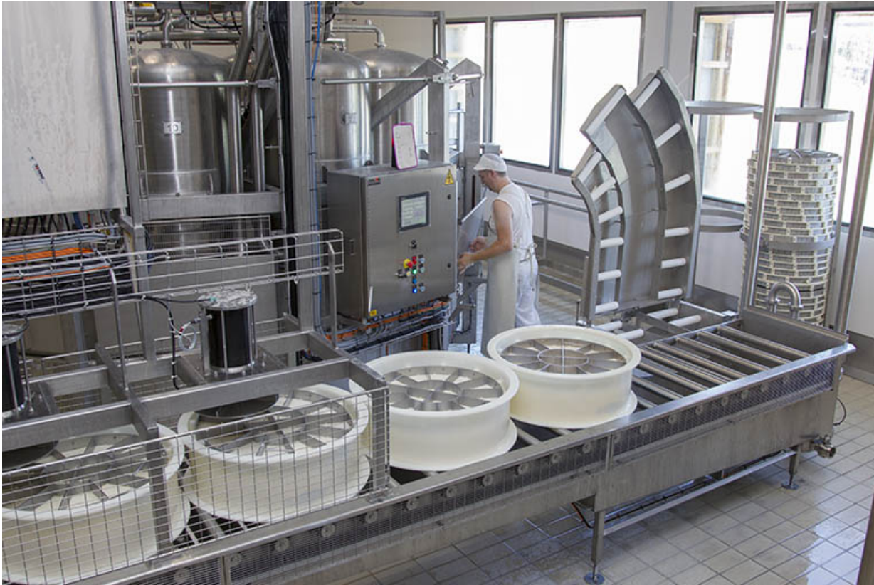
Fabrication : sortie du soutirage sous vide.
