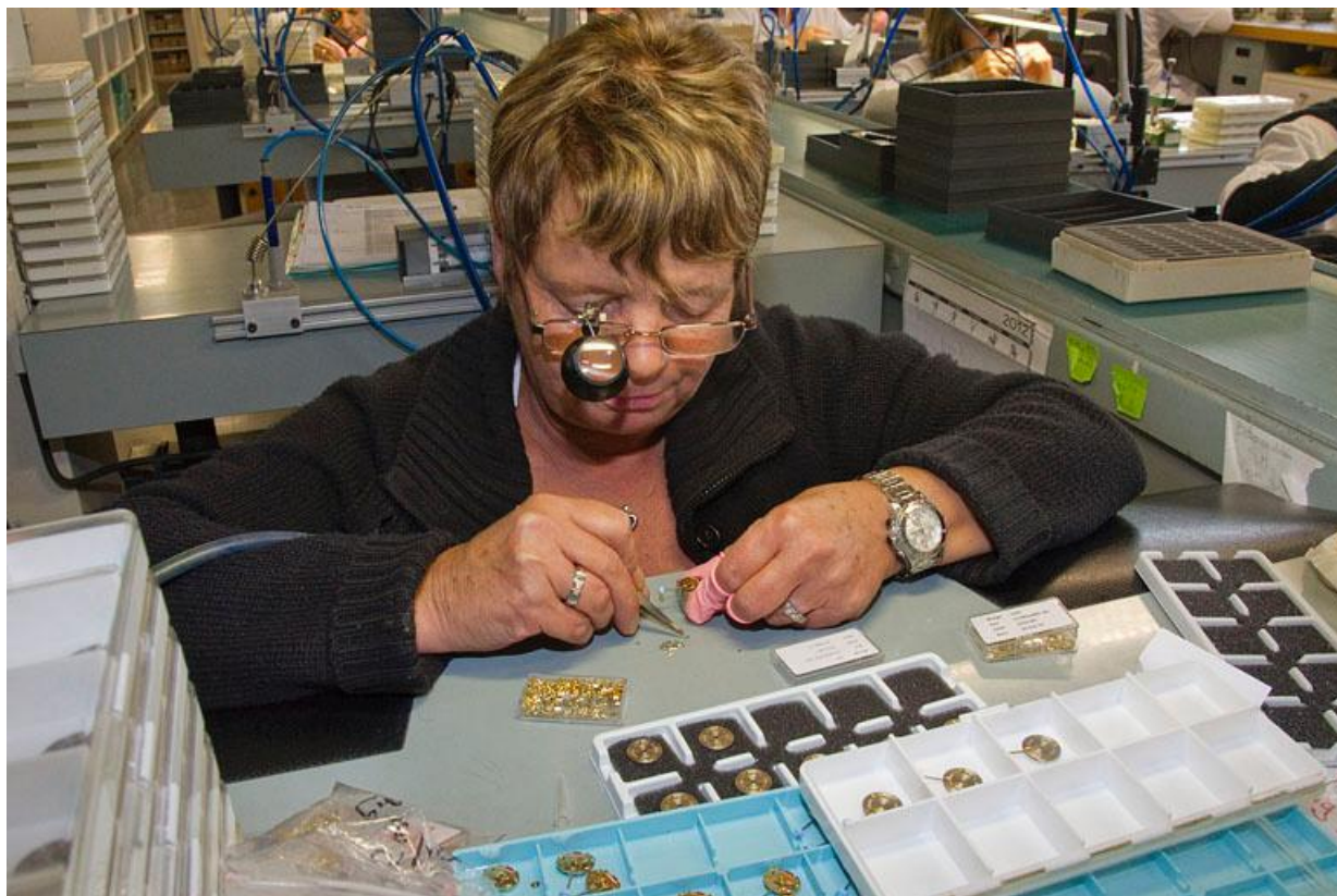
Atelier de fabrication : pose des aiguilles.
