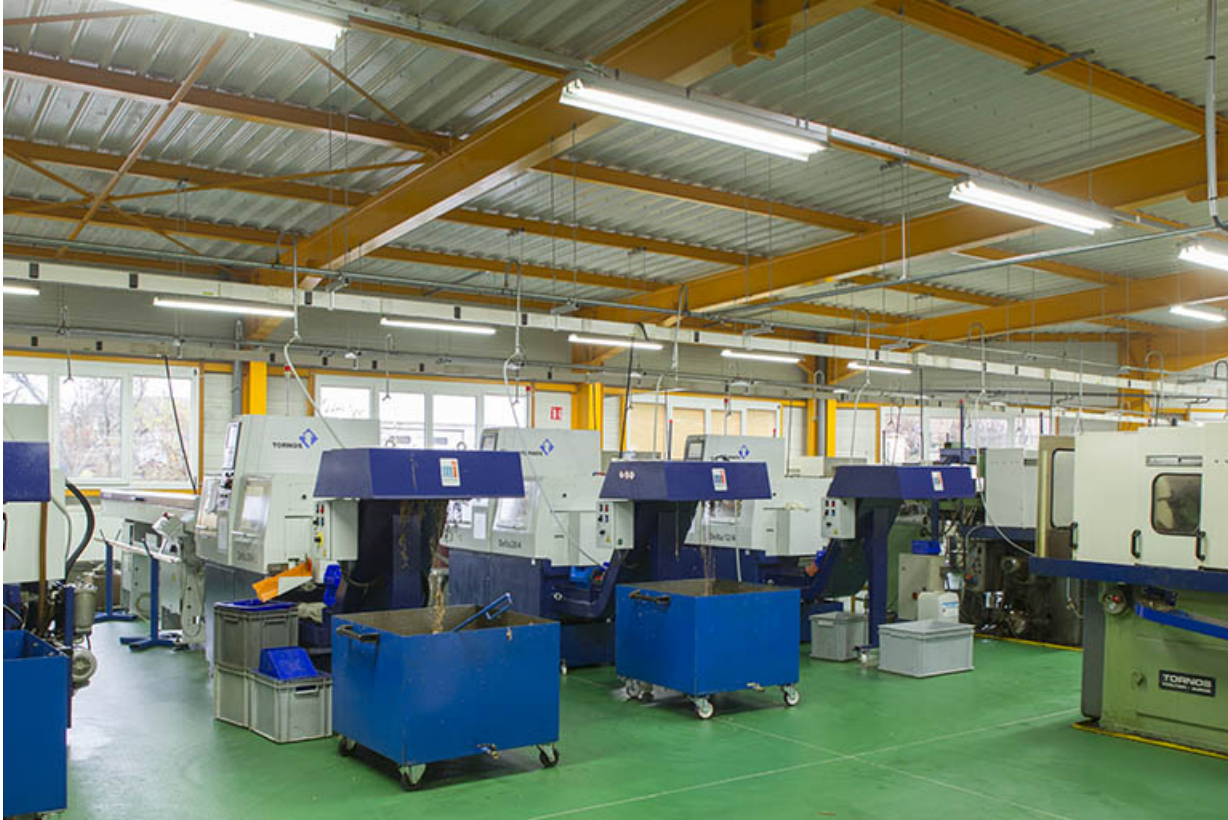
Atelier de décolletage (bâtiment de 1998).
