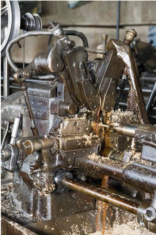
Atelier primitif. Machine à décolleter en action.
