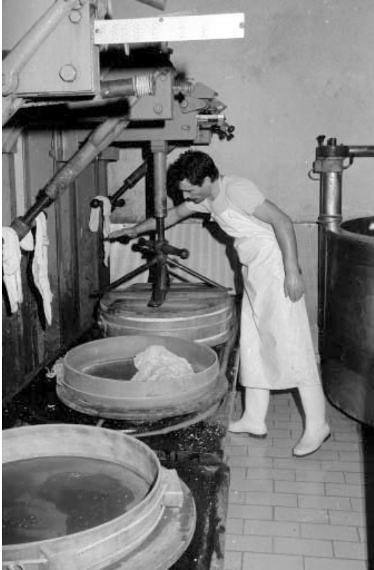
Fabrication du comté : mise sous presse.
