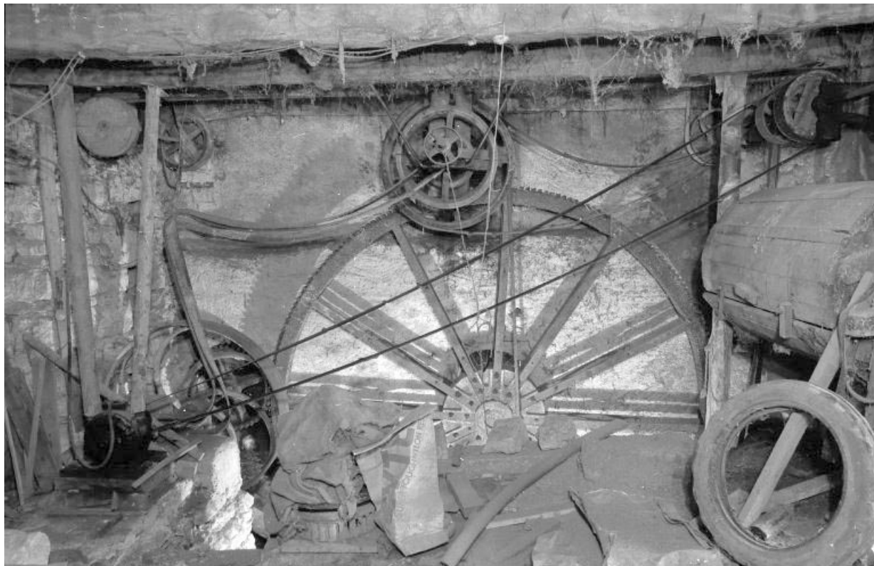
Intérieur de la salle des machines. Moteur électrique, transmission de la roue hydraulique et tonneau de polissage. 39, Viry
