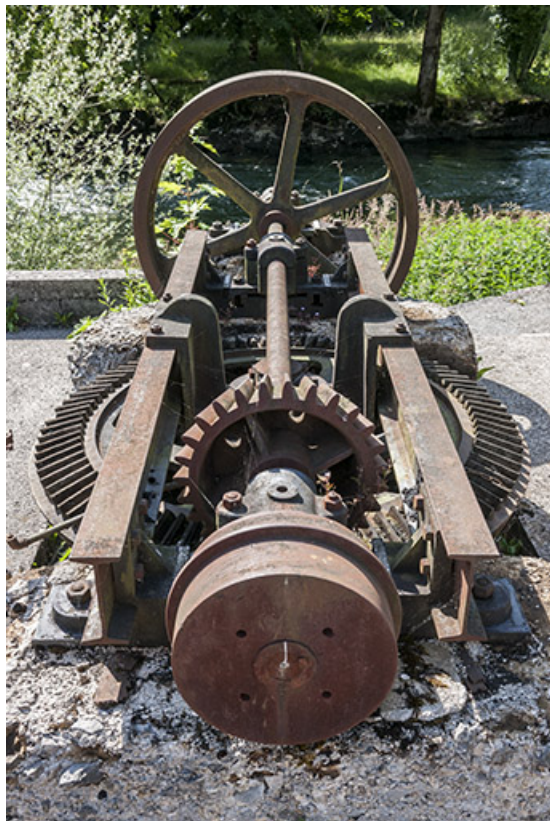
Départ de la transmission de la turbine.
