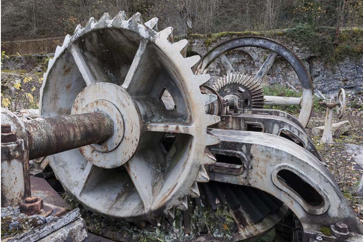
Turbine double. Transmission par engrenage conique.
