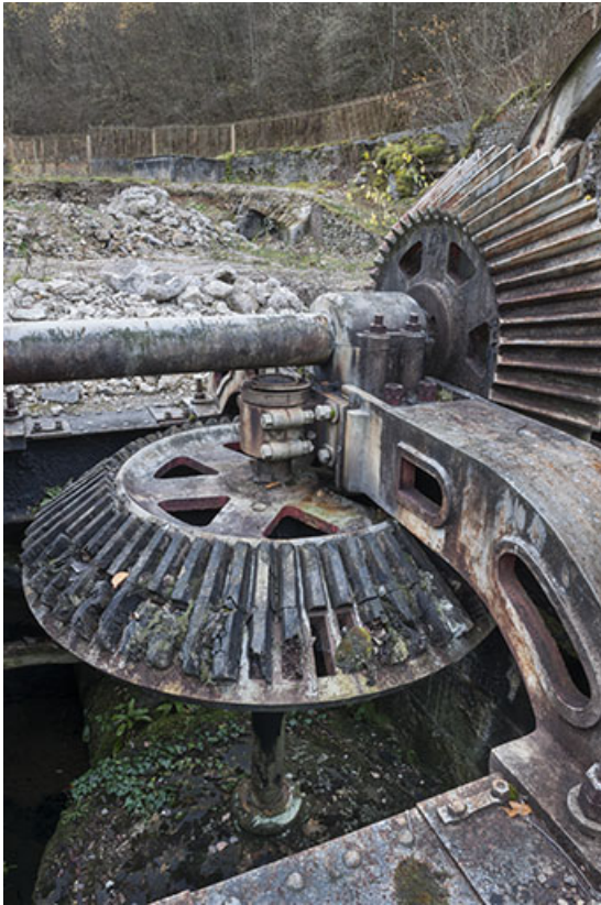
Turbine double. Détail des engrenages coniques.
