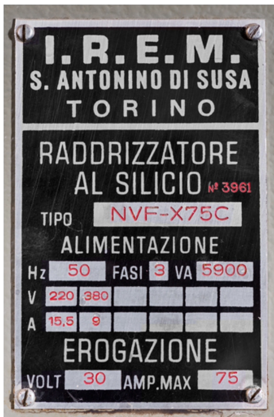
Redresseur IREM : plaque signalétique du constructeur.
