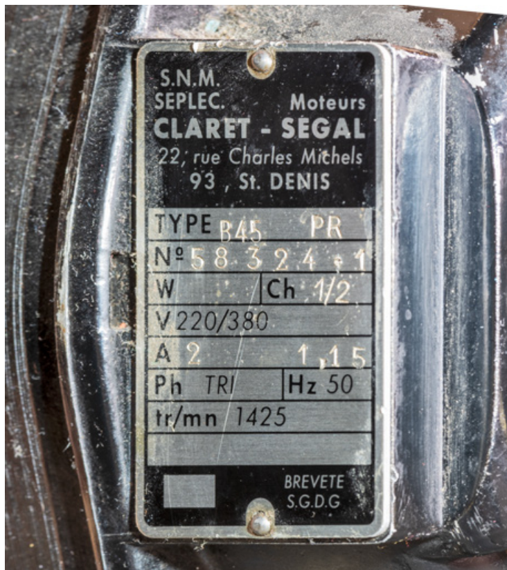
Plaque signalétique sur le moteur Claret-Segal.
