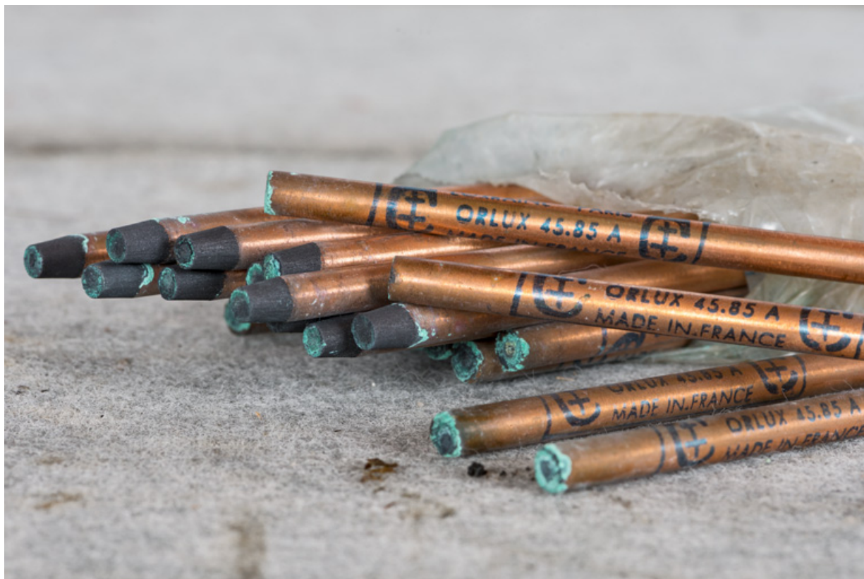
Electrodes pour lampe à arc. 71, La Clayette, 2A rue Faisant
