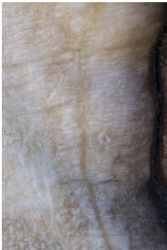
Auguste : altération de l'albâtre au niveau du cou.
