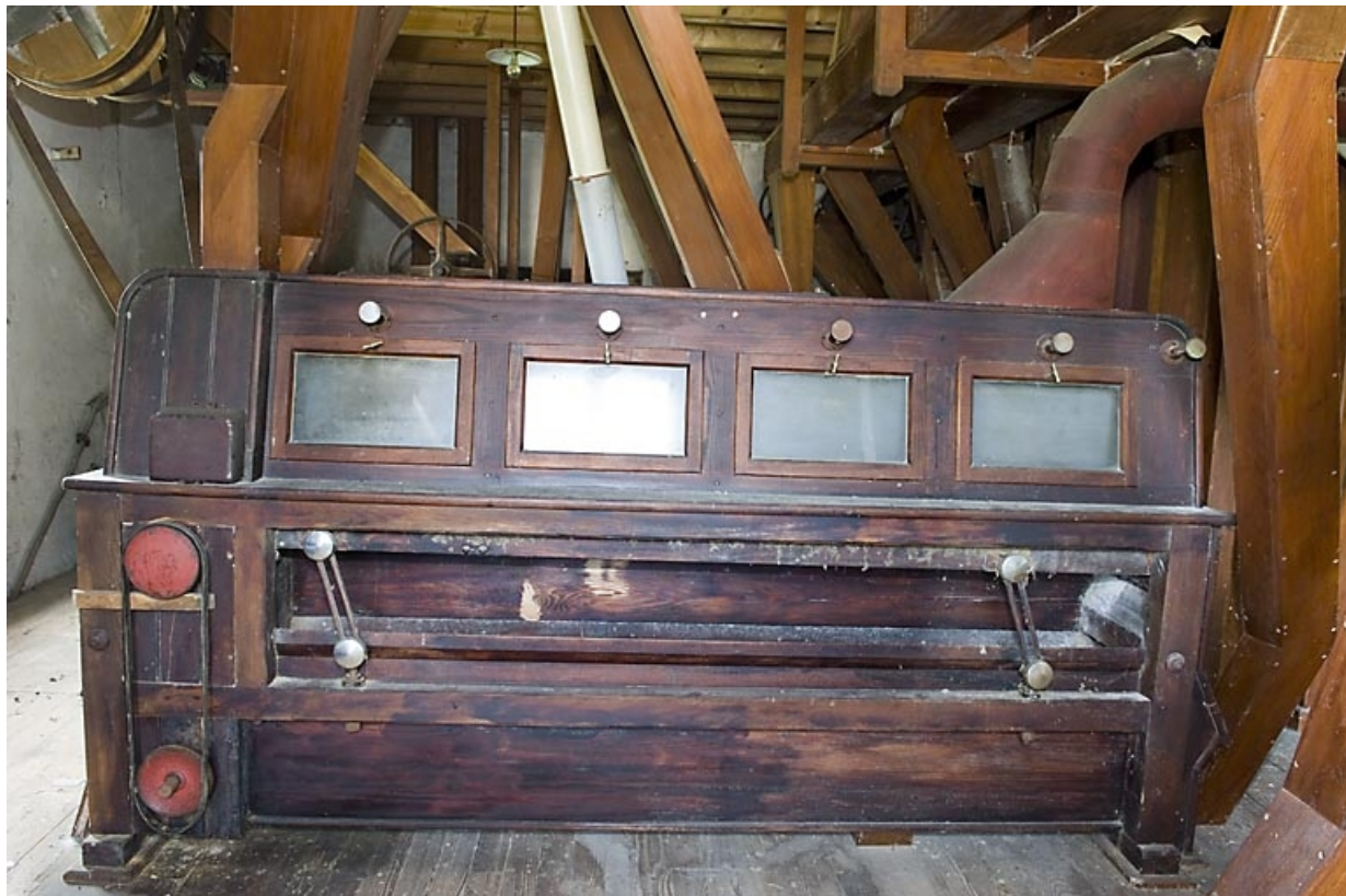
Deuxième étage. Sasseur. Vue de côté.
