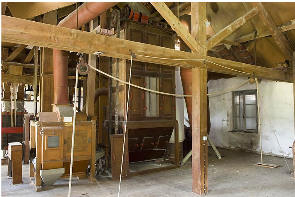
Troisième étage. Brosse à blé Socam et système d'aspiration centrale des Anciens Ets Schneider-Jacquet et Cie. 70, Fougères, lieudit : Fougères-le-Château
