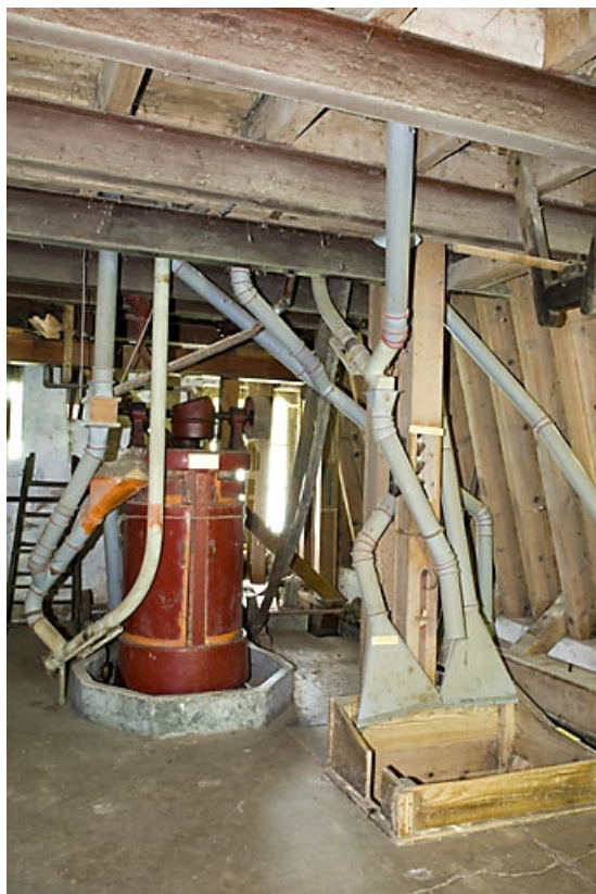
Rez-de-chaussée. Laveuse-essoreuse Teisset-Rose-Brault.
