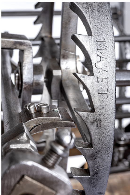
Inscription sur la roue d'échappement : nom du fabricant. 39, Septmoncel
