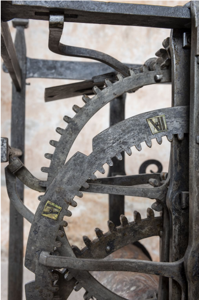
Corps avant gauche (sonnerie des heures) : détail de la roue de compte. 39, Orgelet place de l' Eglise
