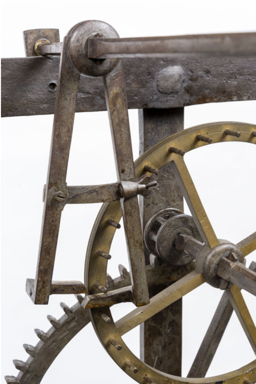
Echappement à chevilles : ancre et roue d'échappement.
