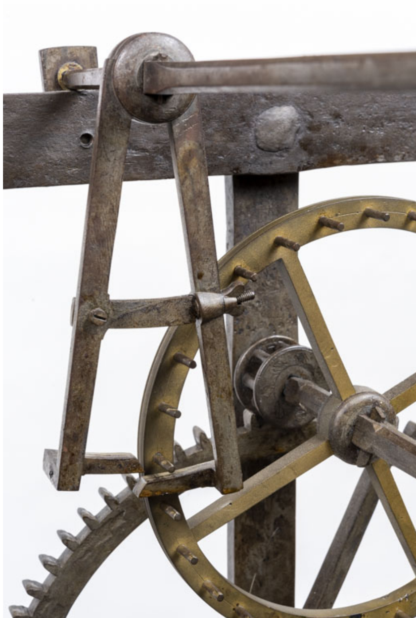
Echappement à chevilles : ancre et roue d'échappement.
