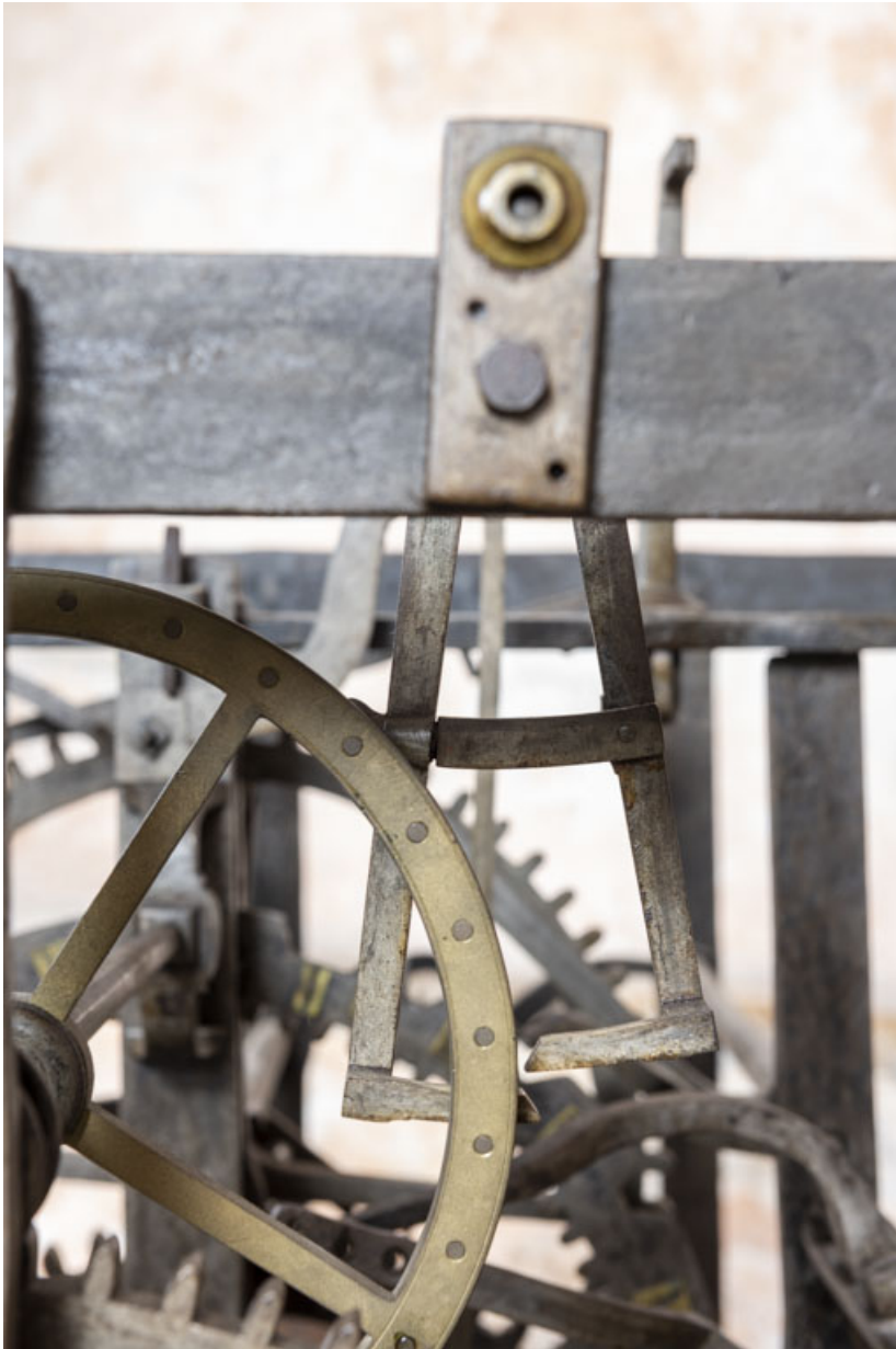
Echappement à chevilles : roue d'échappement au premier plan, en avant de l'ancre. 39, Orgelet place de l' Eglise
