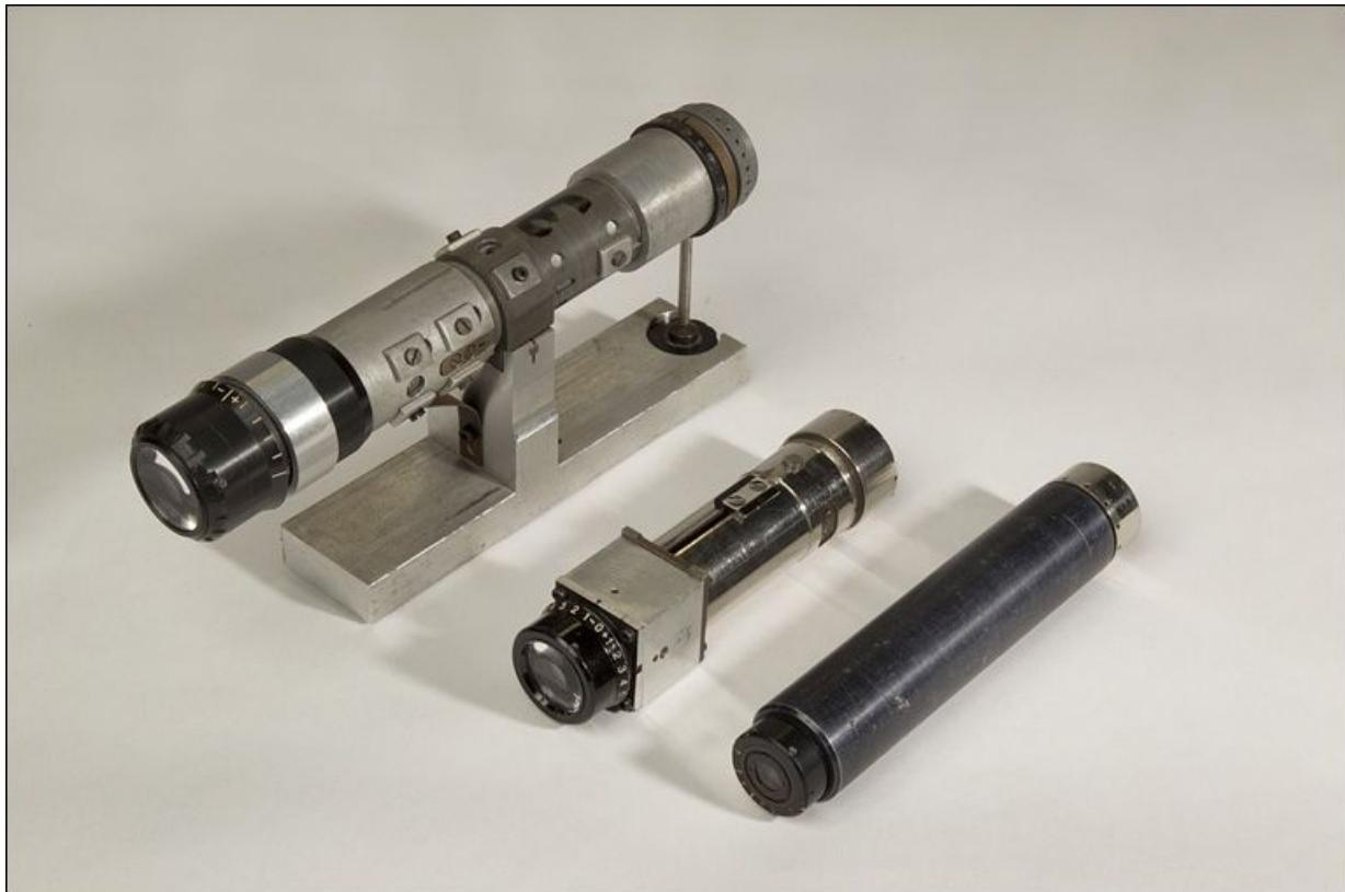
**Trois lunettes optiques. La lunette de gauche est utilisée lors des travaux pratiques pour établir le parallélisme entre son axe optique et son support ; celle de mesure au centre comporte une lentille mobile afin d'ajuster sa distance focale ; la troisième est une lunette de pointage.**
