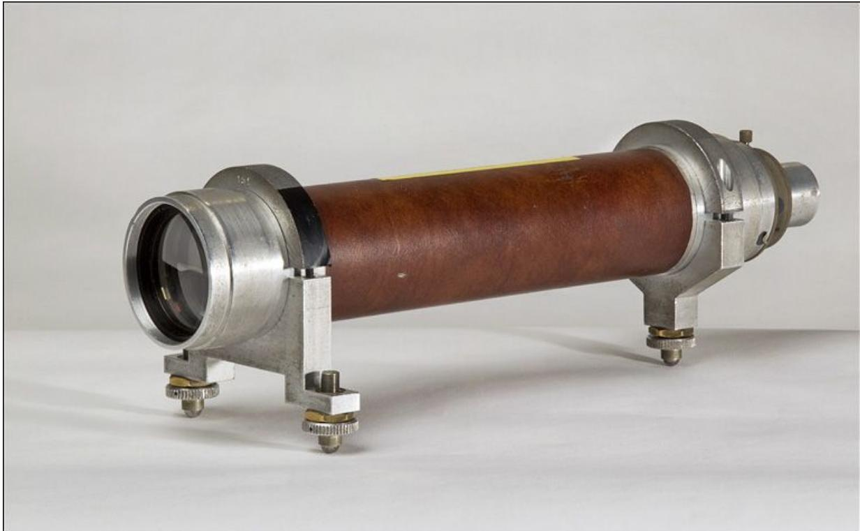
**Collimateur. Il permet à un autre instrument de faire des visées à l'infini.**
