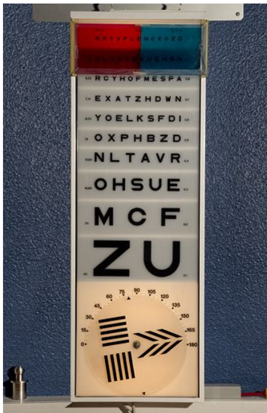
Test de Monoyer, dû à la société Ella (cadran mire-chevrons éclairé). 39, Morez, 35 quai Aimé Lamy
