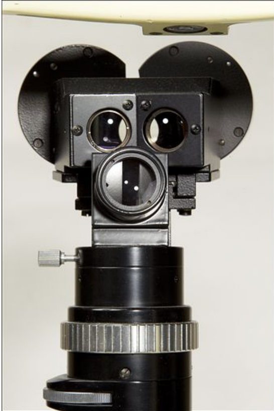
Détail de la partie optique, vue du côté du patient : objectifs et partie arrière de la binoculaire en haut, module d'éclairage et son objectif en bas.
