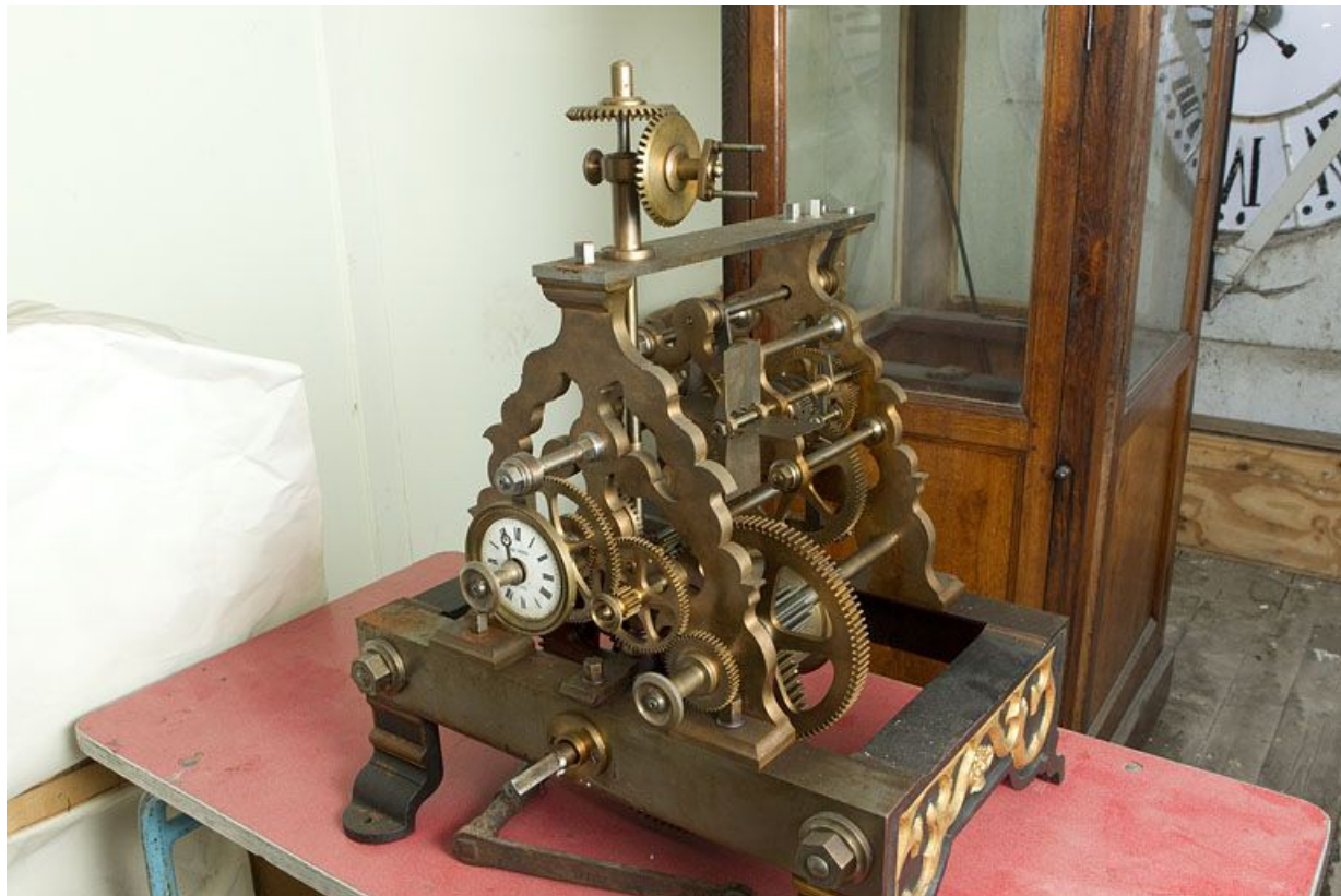
Mouvement : cadran de contrôle et roues dentées.
