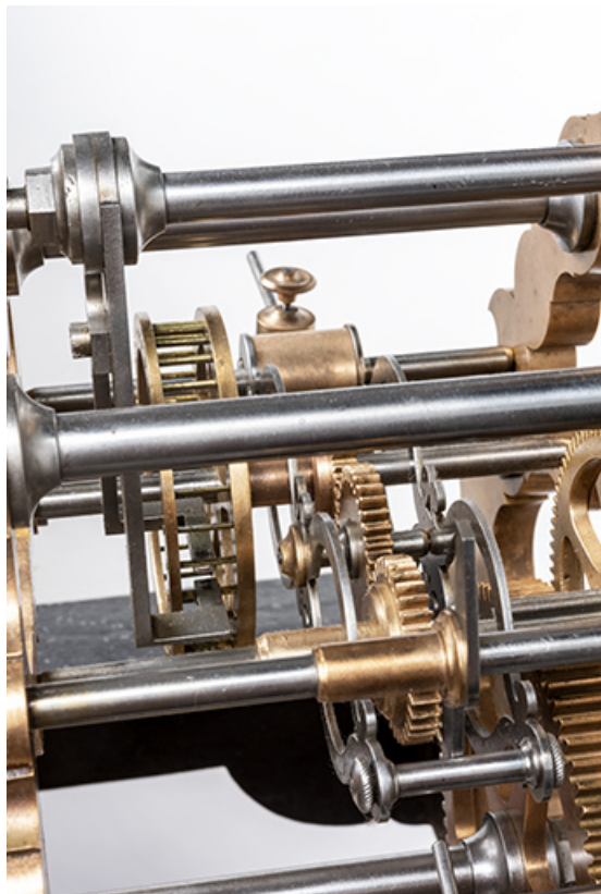
Mouvement : détail de l'échappement.
