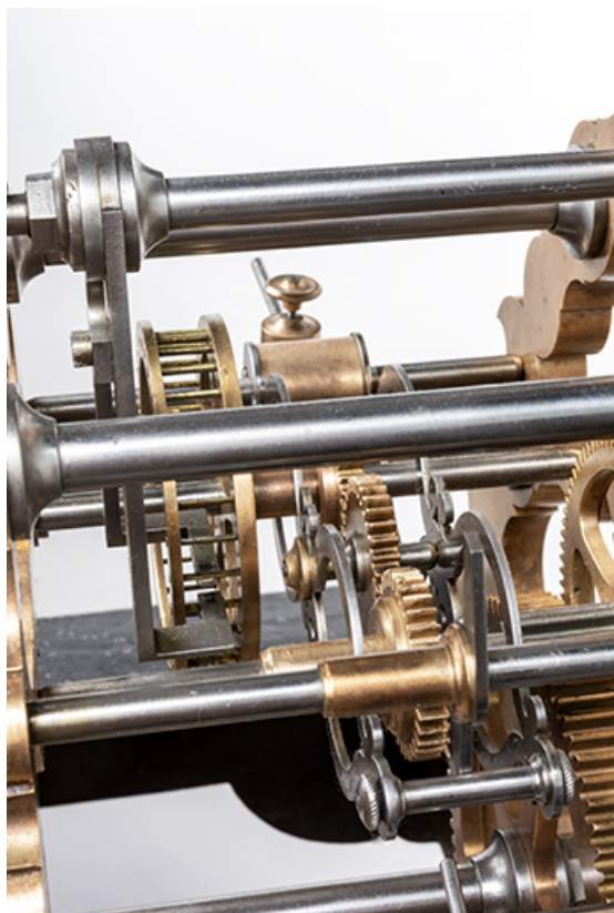
Mouvement : détail de l'échappement.
