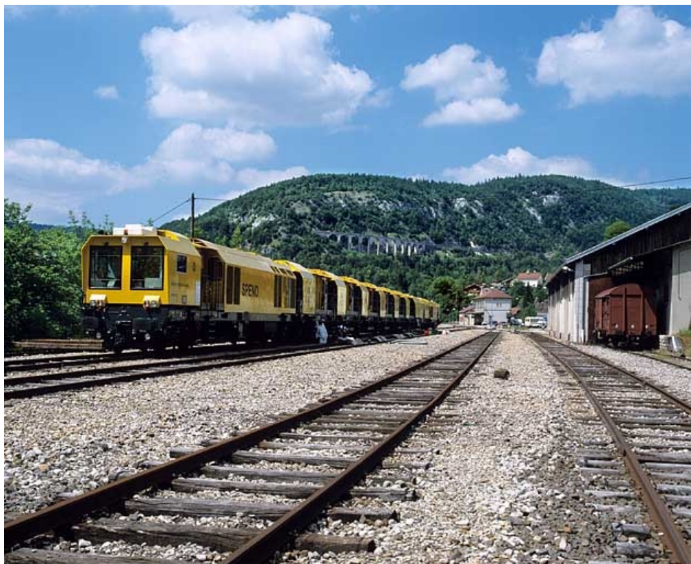
Train de meulage : vue d'ensemble en gare de Morez (trois quarts arrière). in, Jura
