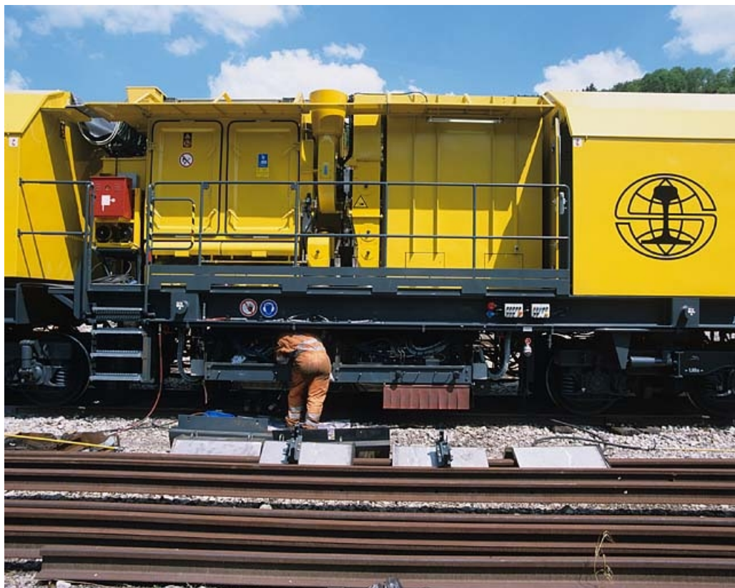
Train de meulage : maintenance et réglages sur l'un des wagons. in, Jura
