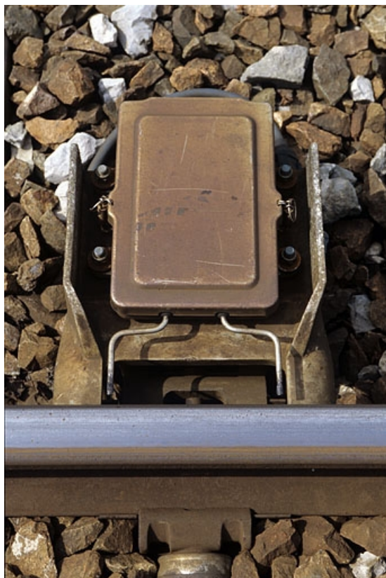
Pédale électromécanique Forflex : vue rapprochée.
