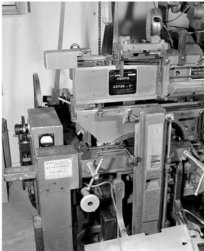
Plaques de constructeur, dans la zone du clichage. La roue-moule est accessible en abaissant la façade avant (partie inférieure de la photographie).
