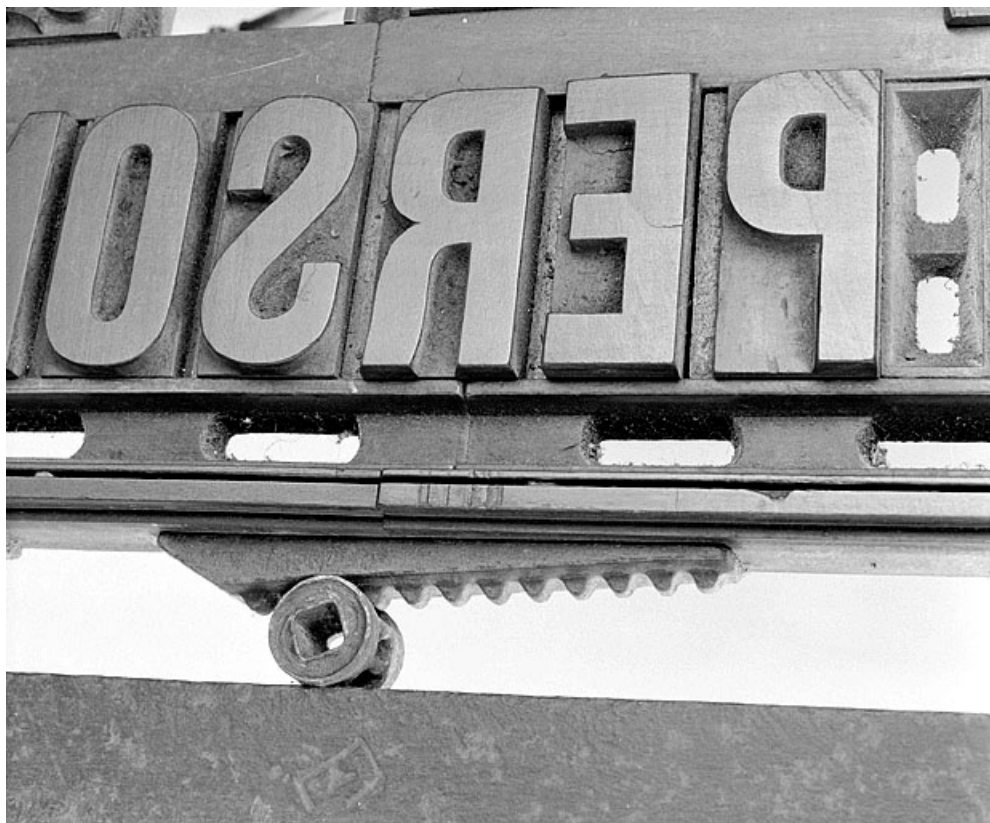
Détail d'un serrage mécanique à crémaillère et pignon.
