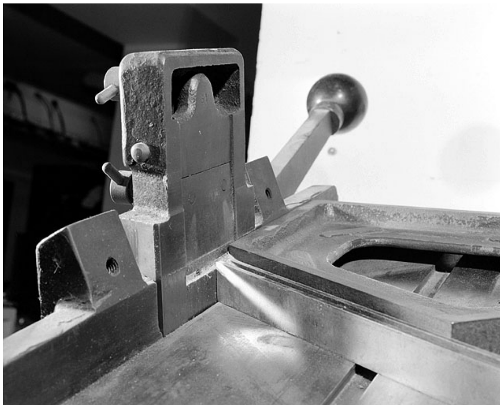
Coupe oblique d'un filet avec le "coupoir-biseautier". Le filet est appuyé contre le guide pentagonal. 39, Saint-Claude, 12 rue de la Poyat
