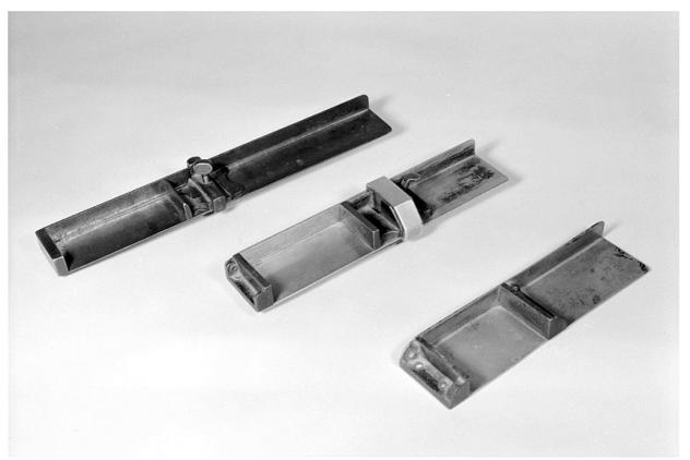
Au premier plan, composteur servant à "lever la lettre" des colonnes de journaux : l'équerre étant rivée, la largeur de la ligne est fixe.
