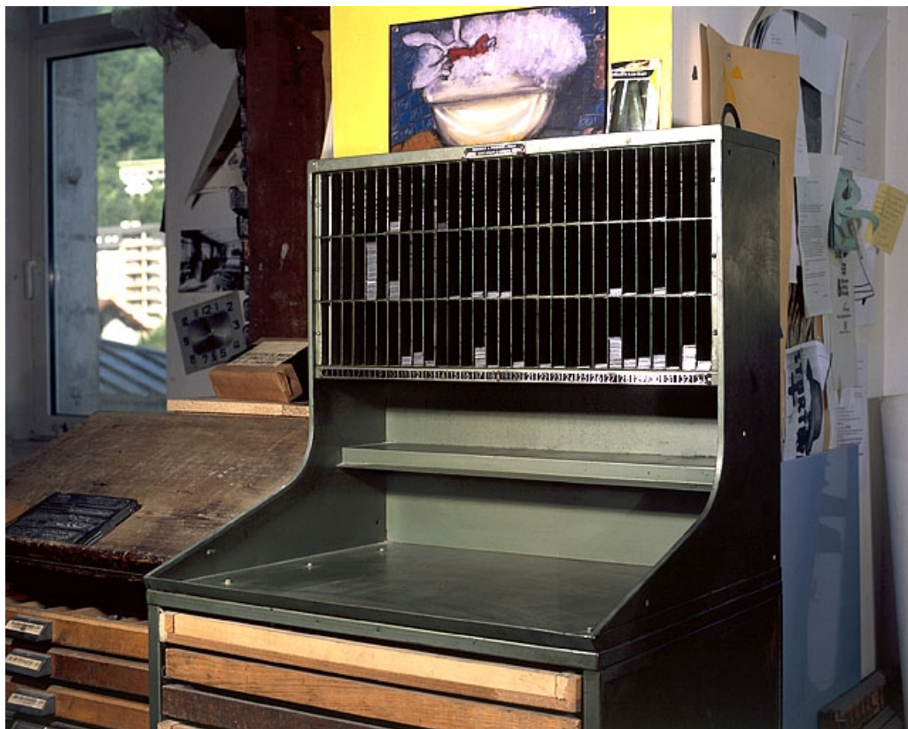
Partie supérieure du rang à pupitre et interlignier. Ici composé d'une tôle formant un plan de travail incliné, le pupitre a été ôté. 39, Saint-Claude, 12 rue de la Poyat
