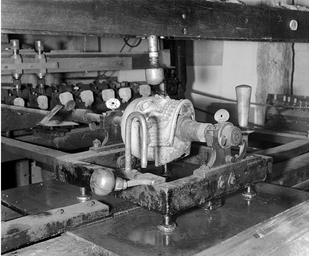
Support du modèle. Bougée à l'aide d'une poignée verticale et d'une poignée horizontale, cette partie du bâti mobile glisse sur une plaque métallique. Noter au-dessus du crâne l'extrémité du palpeur, laissé en position haute.
