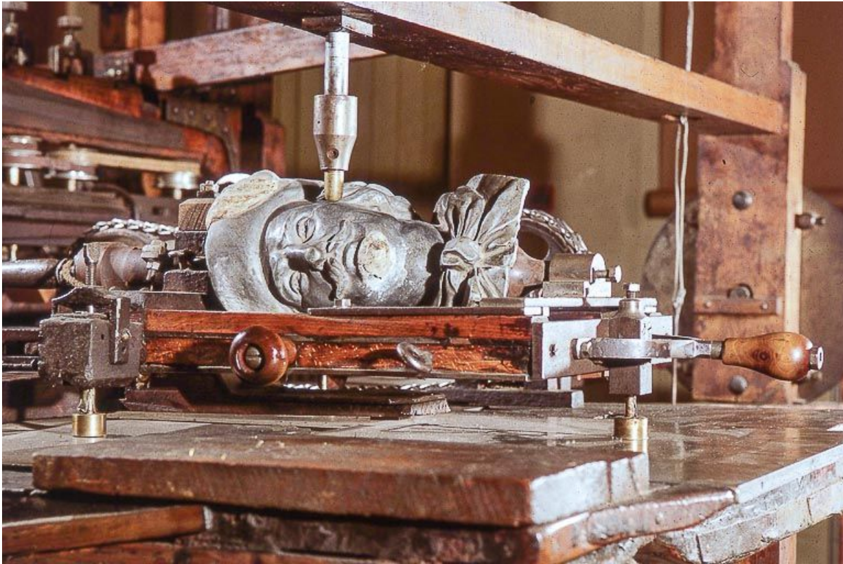
Modèle (d'Artagnan) et son support mobile, vus de trois quarts avant gauche. Manœuvré à l'aide des poignées, le support glisse sur une plaque métallique, chaque détail du modèle pouvant ainsi être retransmis par le palpeur vertical.
