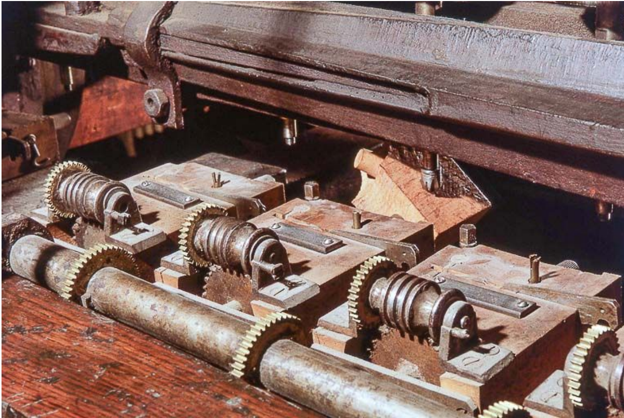
Face arrière : engrenages permettant la rotation simultanée des ébauchons (vue rapprochée).
