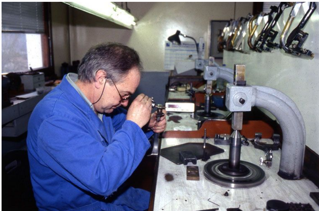
Contrôle en cours de taille d'un diamant. 39, Saint-Claude
