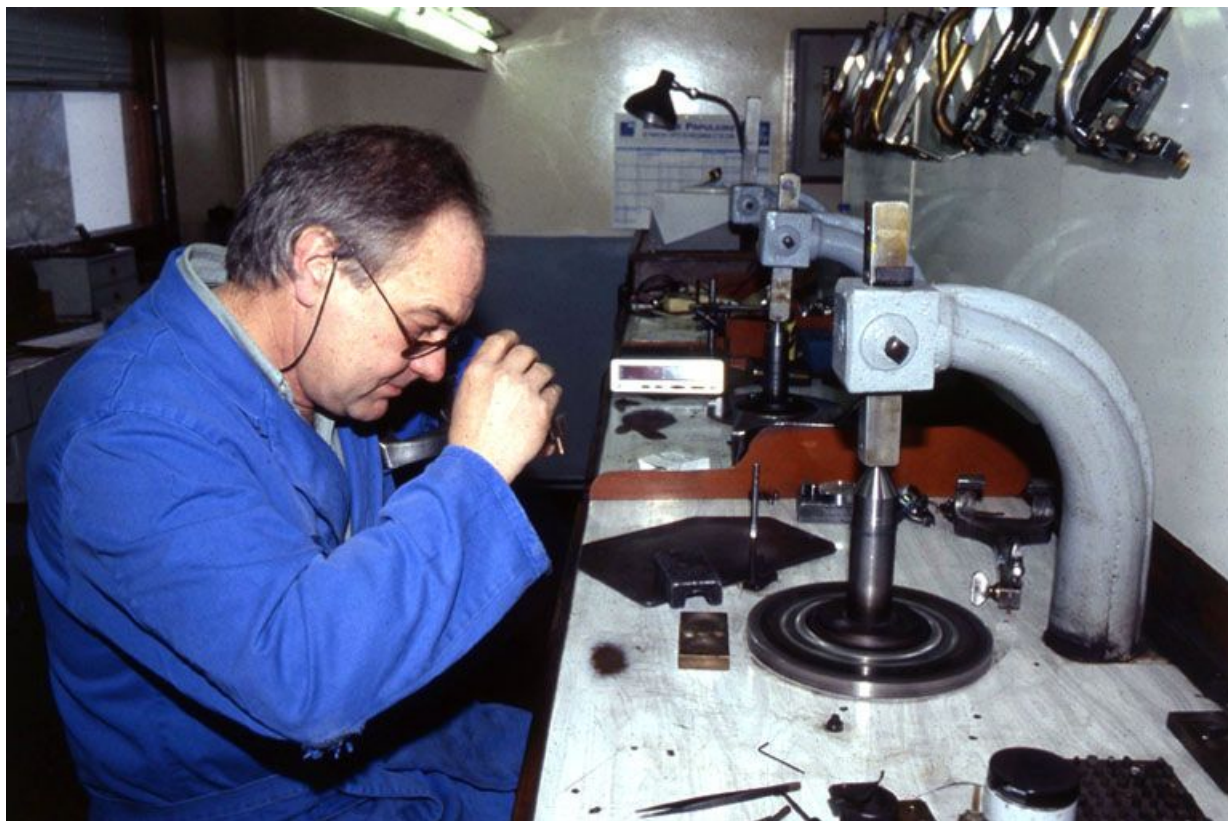
Contrôle en cours de taille d'un diamant.
