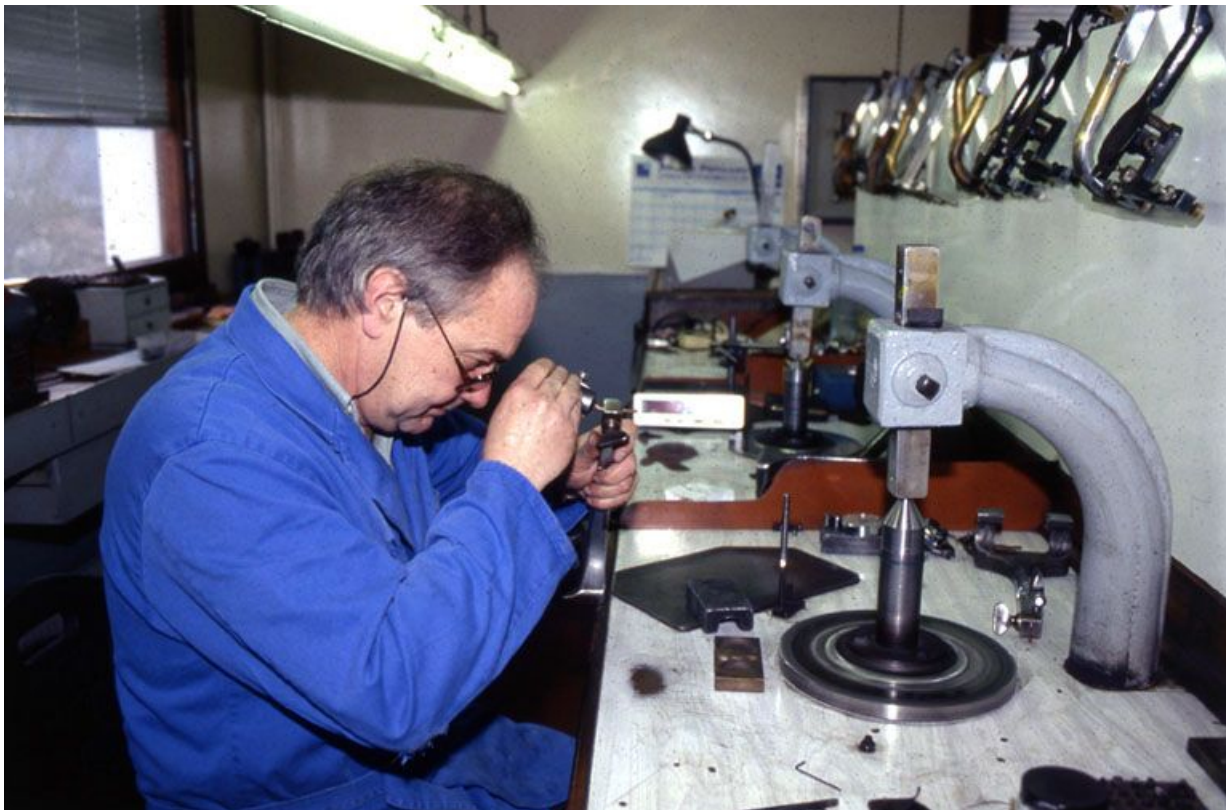
Contrôle en cours de taille d'un diamant.
