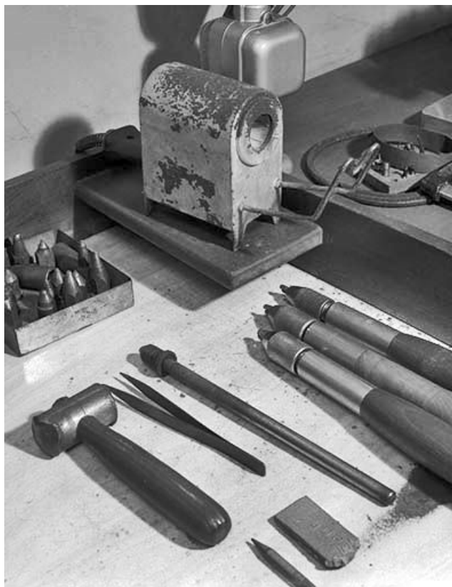
Four à résistance Portius. De gauche à droite, marteau pour désaxer la poupée fixe du tour, pince pour tenir le diamant, bâtons destinés à porter le second diamant. En haut à gauche, mandrins pour la fixation du diamant sur le tour.
