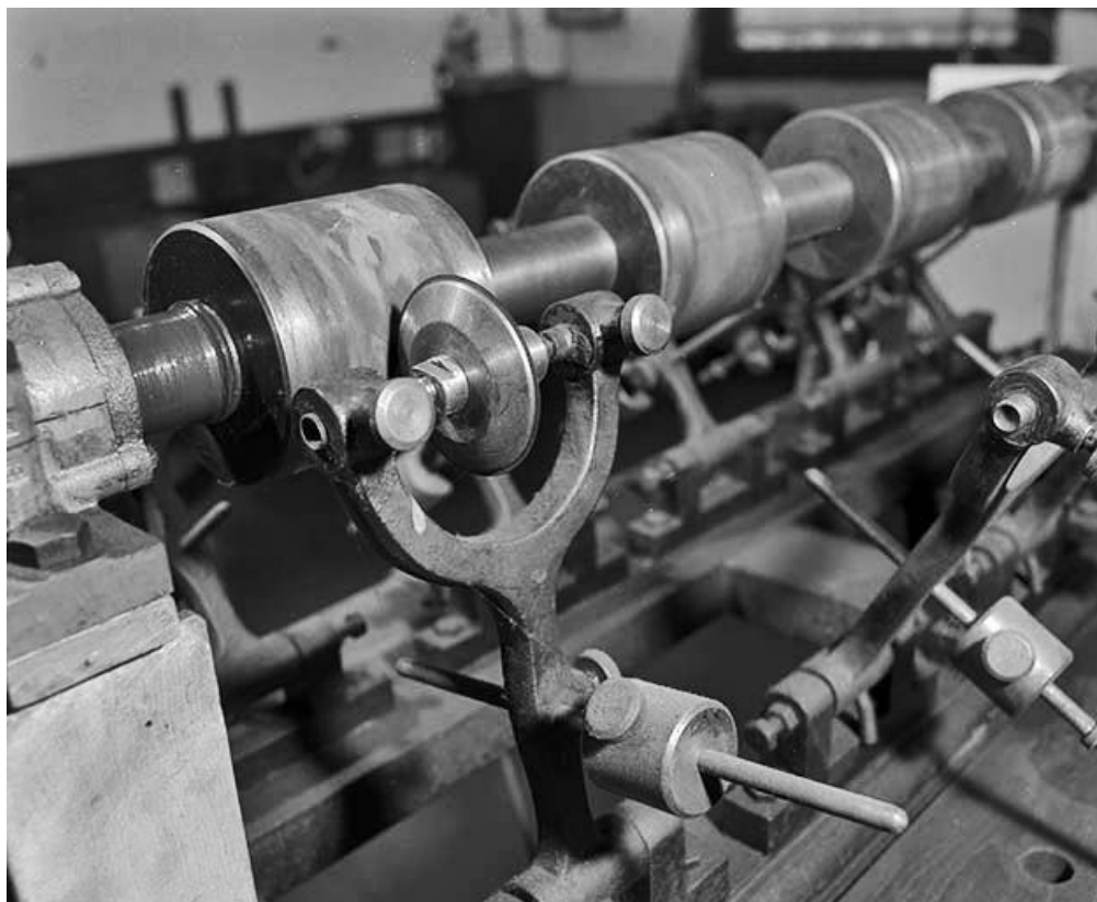
Emplacement de diamantage, avec molette en place.
