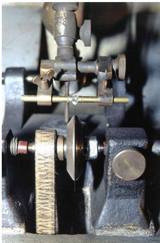
Molette (lame) d'une scie et diamant, vus de face. Pris entre deux mors, le diamant est au contact du disque en bronze phosphoreux, épais de 5 à 10 centièmes de mm.
