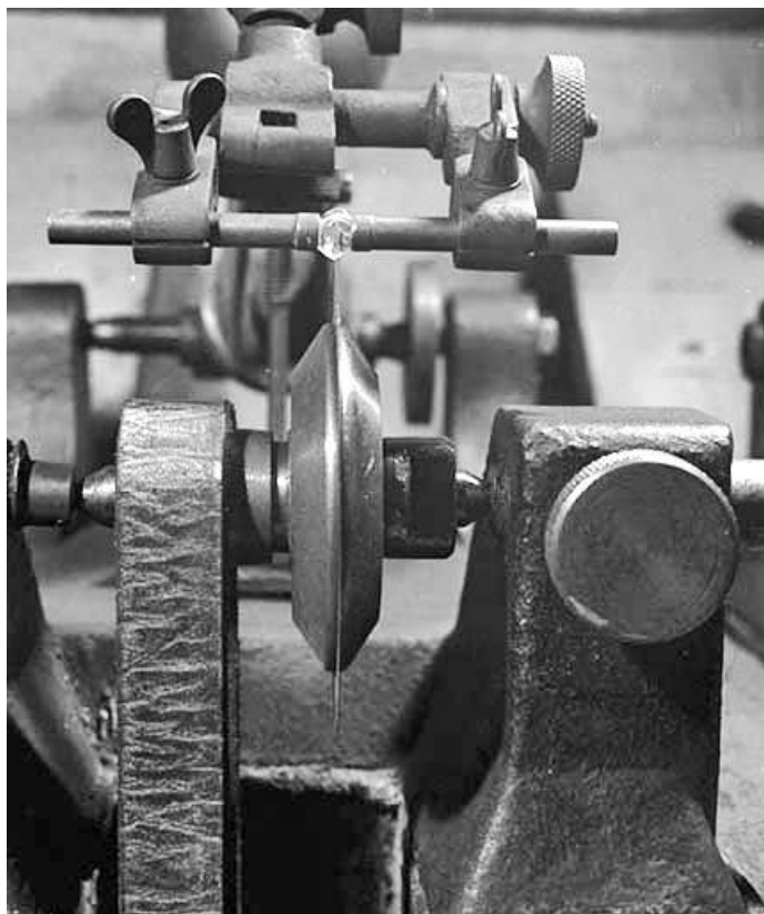
Molette (lame) d'une scie et diamant, vus de face. Pris entre deux mors, le diamant est au contact du disque en bronze phosphoreux, épais de 5 à 10 centièmes de mm.
