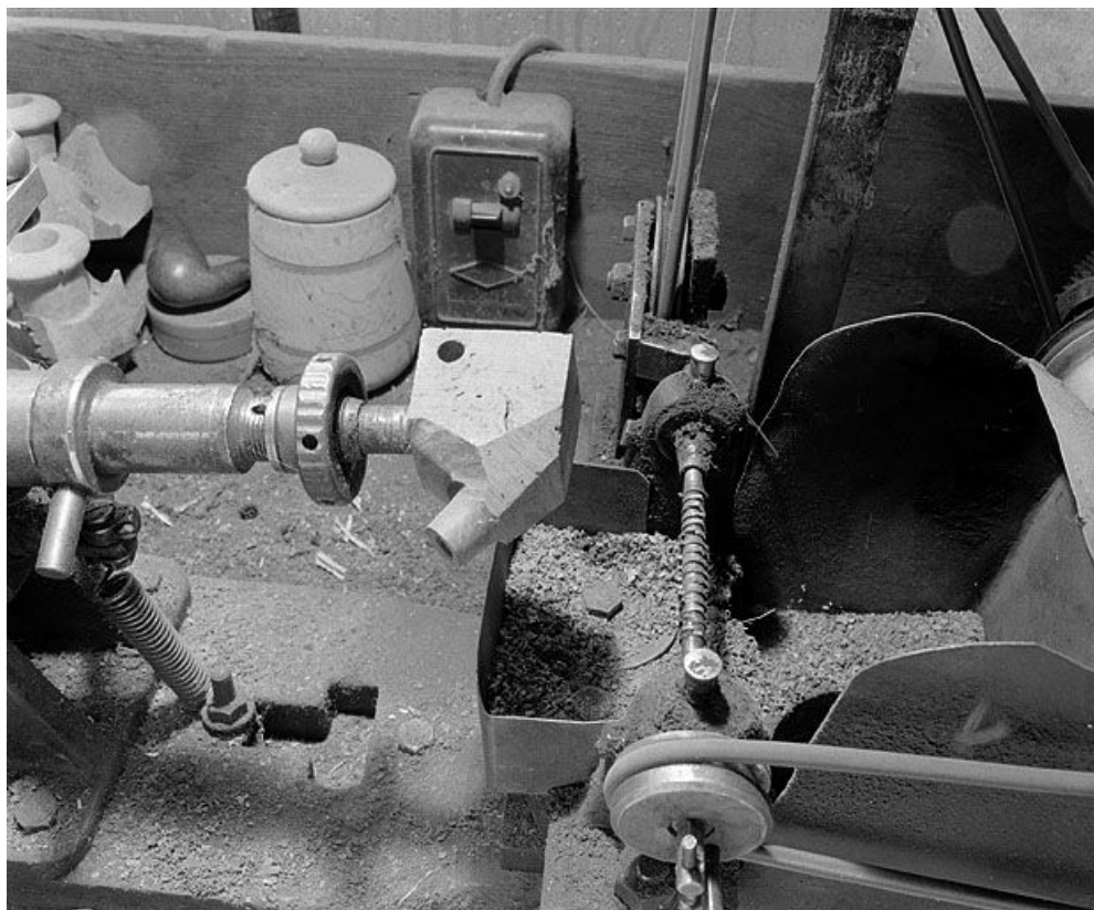
Partie gauche : détail du support de l'ébauchon. A droite, arbre cranté horizontal faisant office de fraise. 39, Saint-Claude, lieudit : Etables
