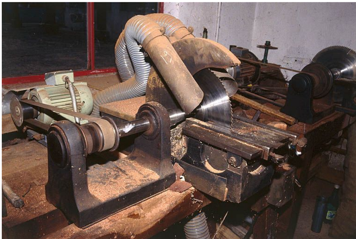
Vue d'ensemble de la scie de gauche, servant au calibrage (dressage des côtés).
