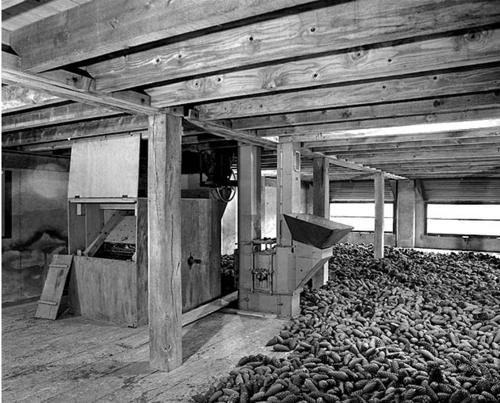
De gauche à droite : batteur, élévateur à godets et aire de séchage des cônes de résineux.
