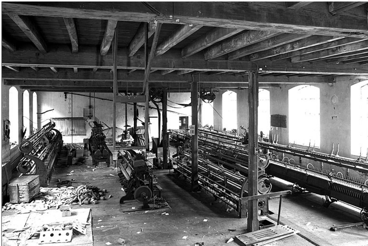
De gauche à droite, machines Ryo-Catteau (moulineuse et assembleuse étudiées, moulineuse non étudiée) et machine Fouvez (moulineuse non étudiée). Tout à droite, renvideur Asa Lees.
