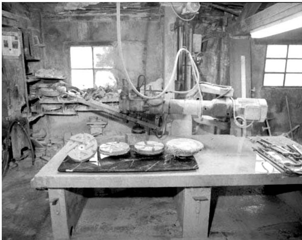
Polissoir à genouillère et ses plateaux. Plateaux à revêtement en carborandum, en acide oxalyque et en cordes. 39, Saint-Amour, 2 à 6 rue de la Marbrerie
