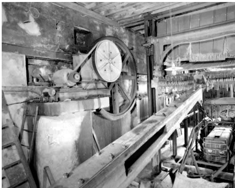
Noria : moteur et système d'entraînement.
