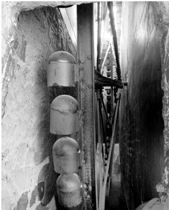
Système de distribution du mélange eau-sable : distributeur et tamis.
