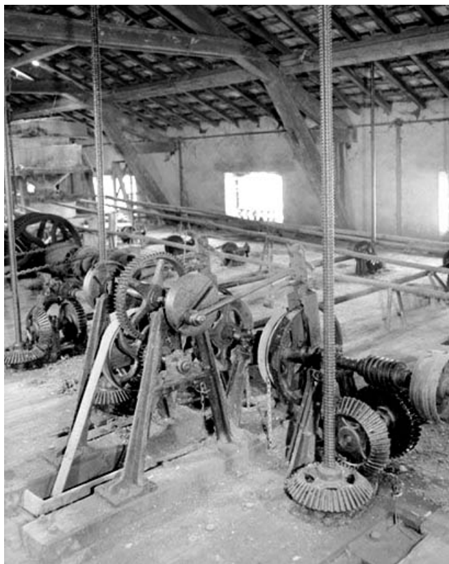
Système de descente à vis : détail.
