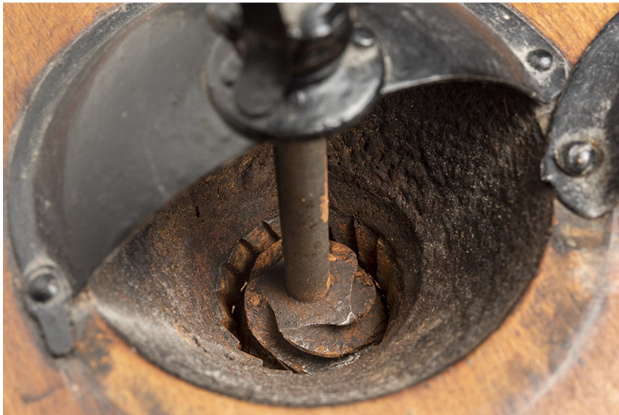
Moulin fabriqué à Pont-de-Roide. Mécanisme de broyage.
