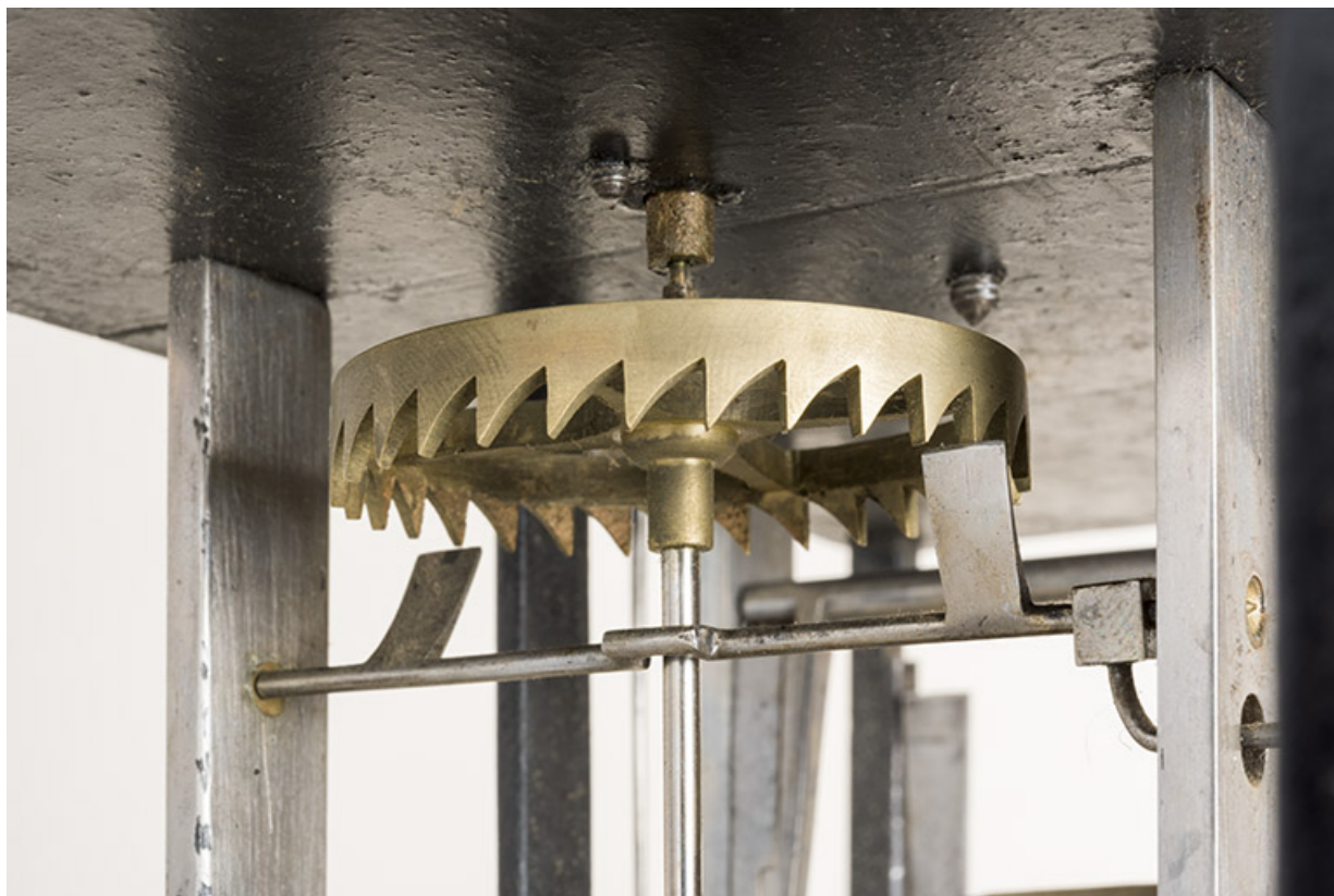
Mouvement d'horloge comtoise, 19e siècle : échappement à verge et roue de rencontre. 25, Morteau, 17 rue de la Glapigney
