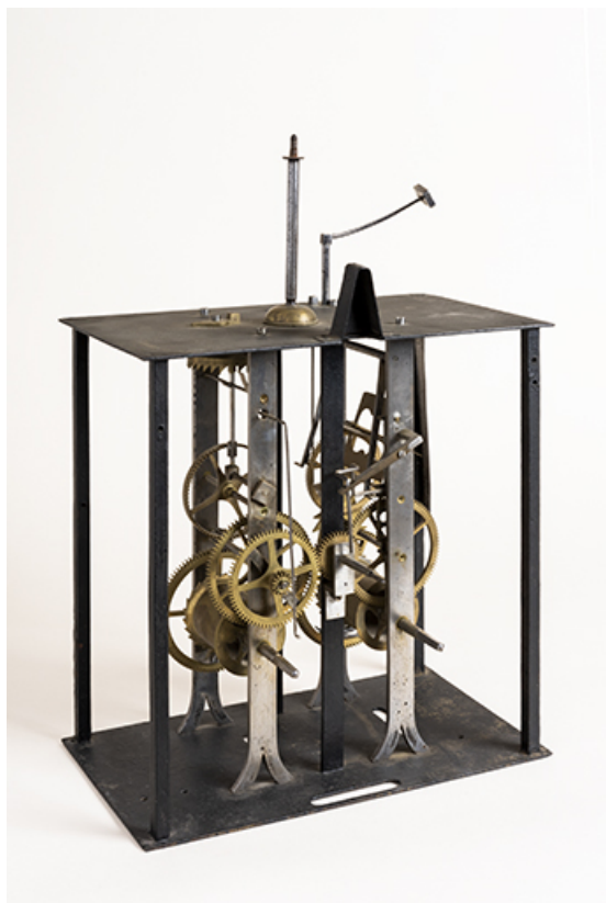
Mouvement d'horloge comtoise (mouvement "cage fer"), 19e siècle. 25, Morteau, 17 rue de la Glapigney
