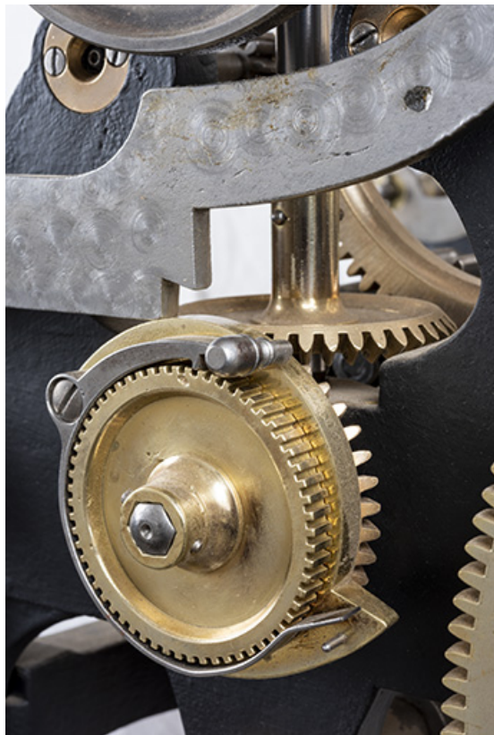
Mouvement, mécanisme des heures : roue dentée et pignons de renvoi. 25, Mamirolle, 10 rue des Quatre Vents
