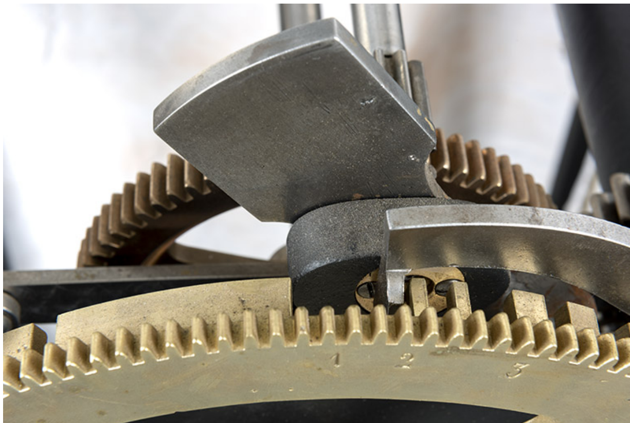
Mouvement, mécanisme des sonneries : système de la roue de compte.
