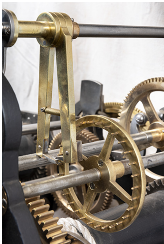
Mouvement, mécanisme des heures : échappement à chevilles.
